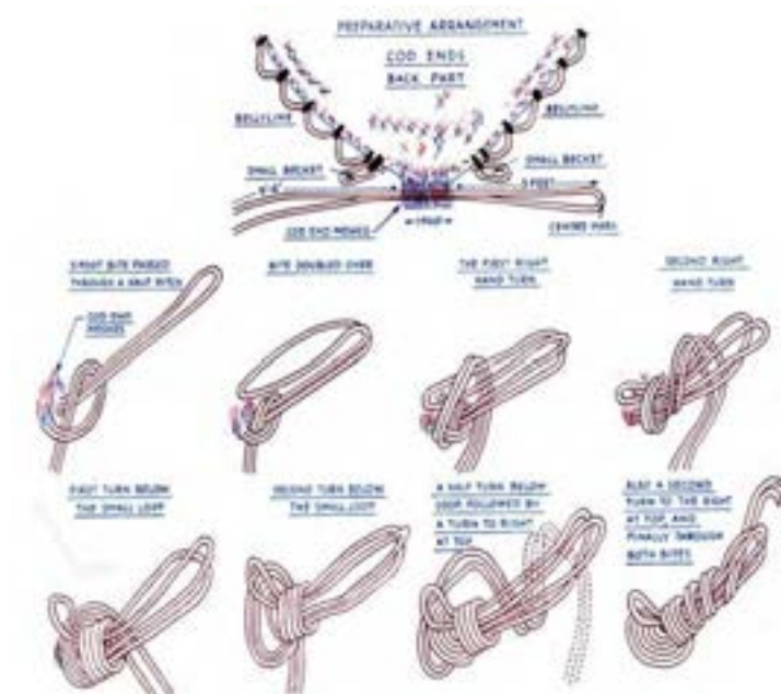
شکل ۲۲- مراحل مختلف برای گره زدن در قسمت انتهای ساک تور
