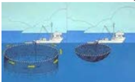
شکل ۳۵- عملیات ماهیگیری با تور گردان پیاله‌ای
