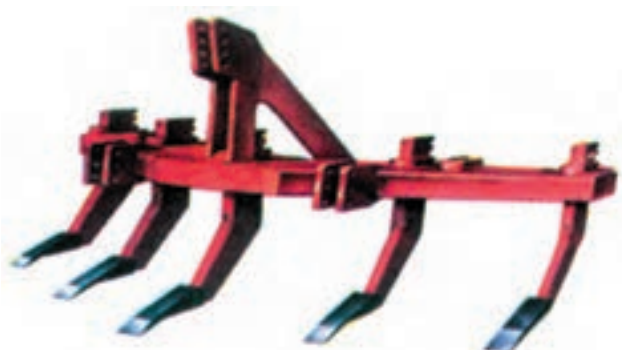
شکل ۱۹-۲- گاو آهن قلمی (چیزل)
