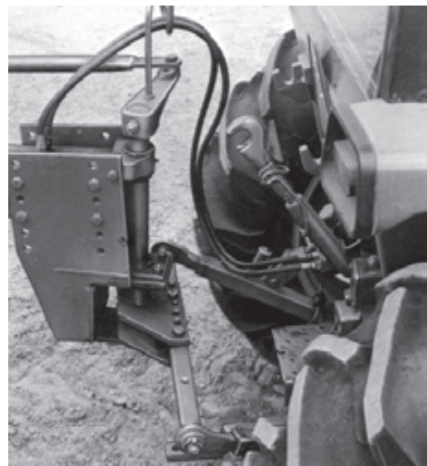
شکل ۲-۷۵- برقراری اتصال بازوها و اتصال هیدرولیکی
