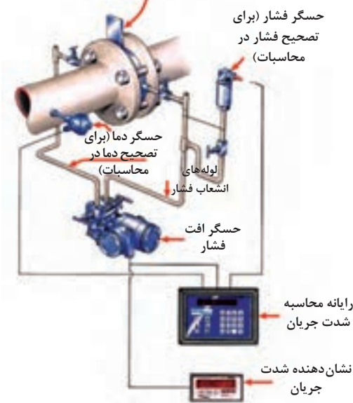
ب) صفحه منفذدار (اریفیس) و انشعاب‌های فشار روی فلنج
