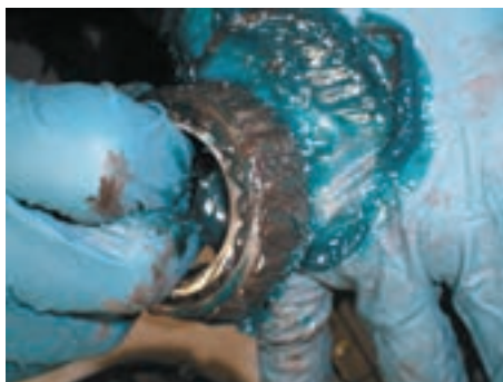
شکل ۲۰- روش گریس کاری رولبرینگ به صورت دستی
