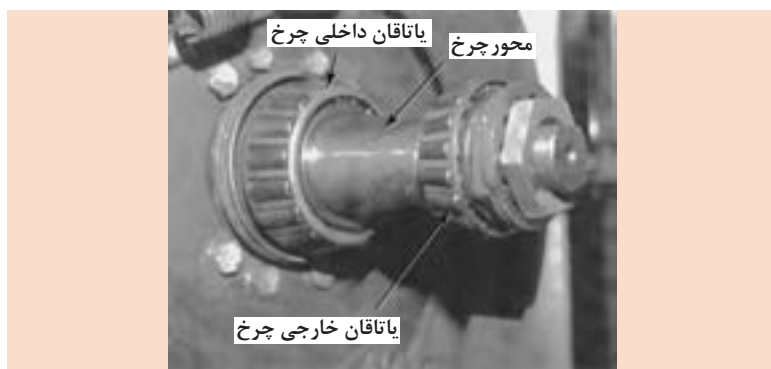
شکل ۱۵- تویی چرخ غیرمحرک مجهز به یاتاقان داخلی و خارجی مخروطی.
