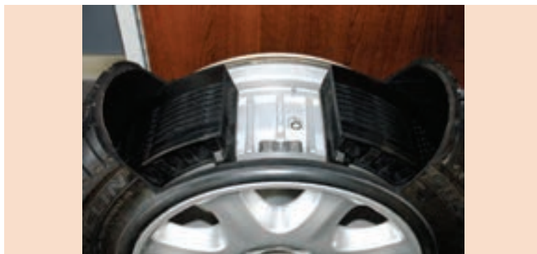
شکل ۵- تایر با لایه محافظ رینگ
