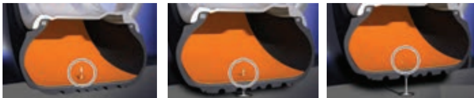
شکل ۴- عملکرد تایر self sealing
