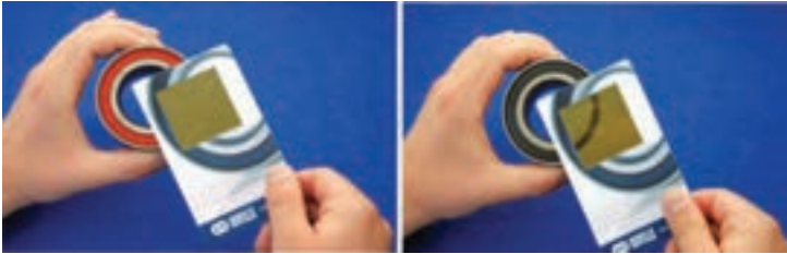
شکل ۱۸- ابزار تشخیص مگنت روی بلبرینگ
