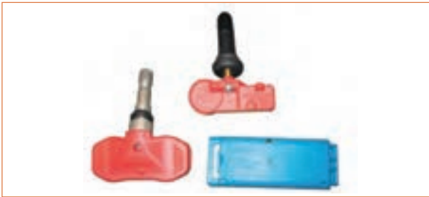
شکل ۹- سنسور TPMS از نوع Direct
