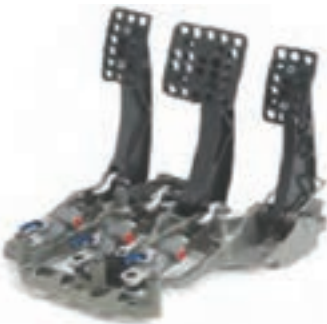
شکل ۱۱- پدال نصب شده در کف اتاق
