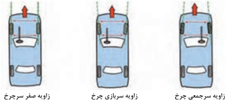
شکل ۳۱- زاویه تو (زاویه انحراف سر چرخ)
