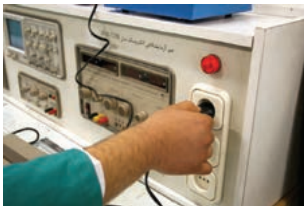
شکل ۱-۳۸ اتصال صحیح دو شاخه
