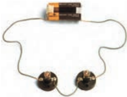
شکل ۲۹-۲ مدار واقعی دو لامپ به صورت سری
