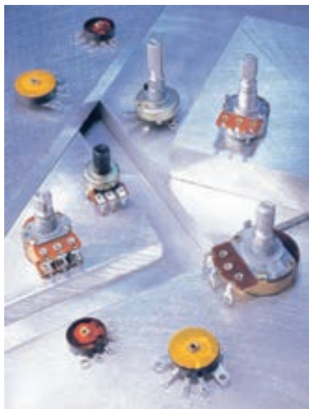
شکل ۲-۴ چند نمونه پتانسیومتر پر کاربرد در الکترونیک
