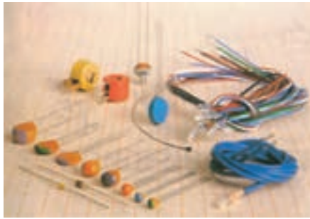
شکل ۱-۲ چند نمونه از مقاومت های NTC و علامت اختصاری آن
