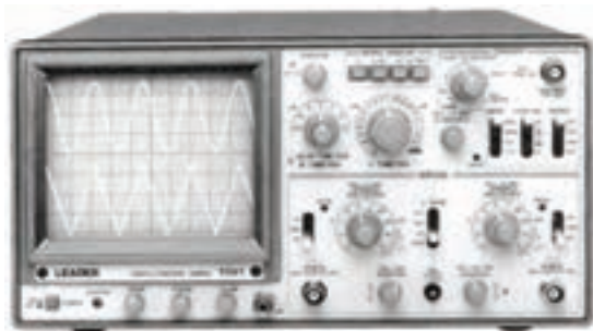
شکل ۶-۳۵ نمایش همزمان دو شکل موج توسط اسیلوسکوپ
