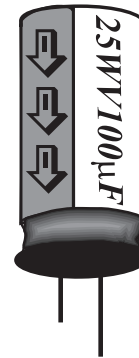
شکل ۷-۳۰ ولتاژ مجاز خازن
