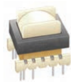
شکل ۳۰-۱۱ ساختمان یک نوع ترانسفورماتور
