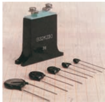
شکل ۱۴-۲ شکل ظاهری واریستور و نماد آن
