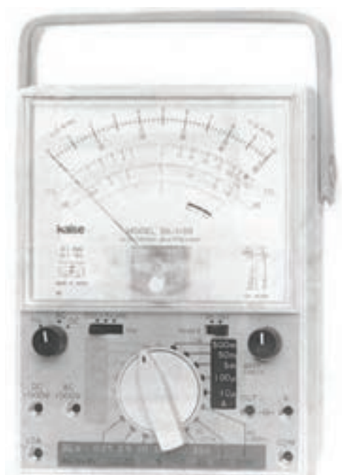
شکل ۲۲-۲ یک نمونه مولتی‌تر عقربه‌ای (آنالوگ)
