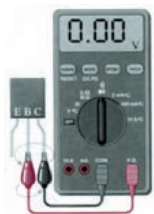
شکل ۱۲-۵۰ ترانزیستور معیوب (اتصال کوتاه)
