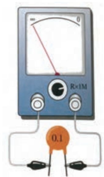
شکل ۷-۵۱ خازن قطع است
