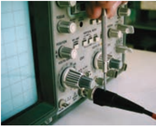
شکل ۸-۶ نحوه‌ی تنظیم پروب
