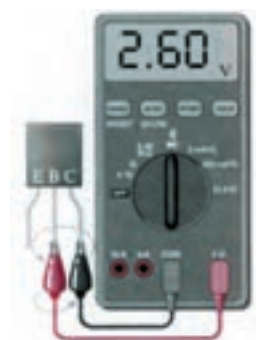
شکل ۱۲-۴۹ ترانزیستور معیوب (قطع)
