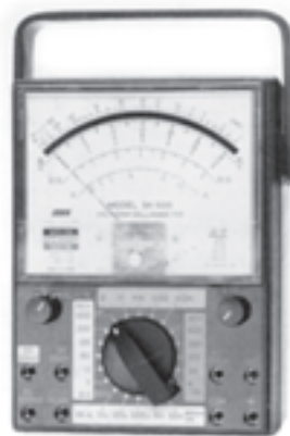
شکل ۲۳-۲ یک نمونه مولتی متر عقربه ای (آنالوگ)
