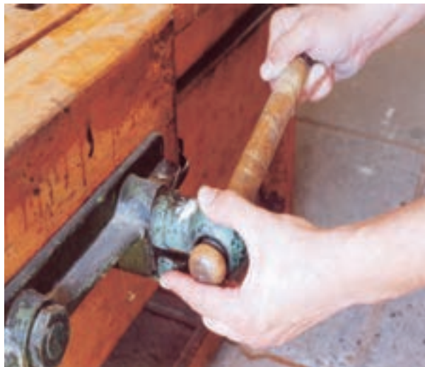
شکل ۲-۱۸- ضامن باز و بسته کردن آزاد گیره.
