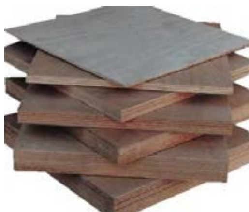
شکل ۳-۴۸ - انواع تخته پندلایه، با ضخامت‌های متفاوت.
