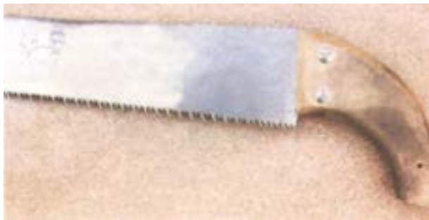
شکل ۵-۳- اره‌ی دندانه‌رو به عقب.
