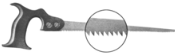
شکل ۵-۱۳- اره نوکی، با بزرگنمایی دندان‌ها.
