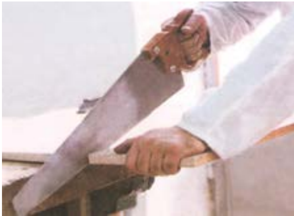
شکل ۵-۸- نمونه‌ی برش به وسیله ارّه دُم (روباهی).
