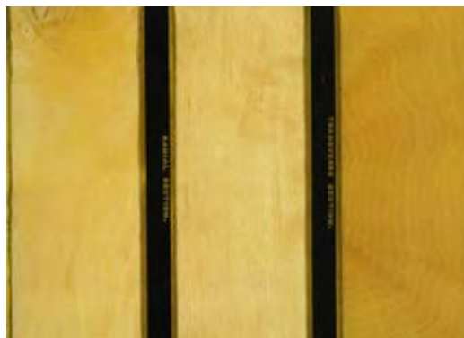
شکل ۳-۲۰- برش‌های عرضی، شعاعی و مماسی چوب ممرز
