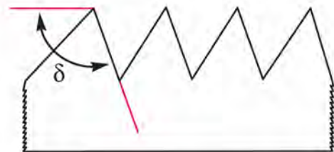
شکل ۵-۳۳- زاویه‌ی برش \delta بیشتر از ۹۰ درجه.
