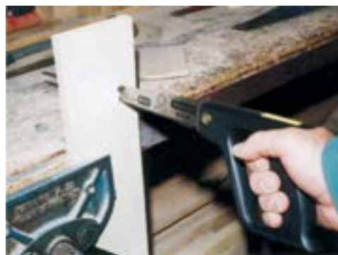
شکل ۵-۵۹- نمونه‌ی ایجاد سوراخ به وسیله‌ی اره نوکی.
