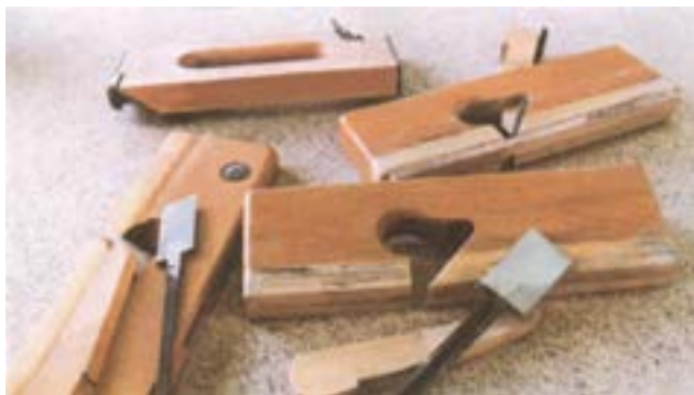
شکل ۶-۳۵- انواع رنده‌های بغل از لحاظ عرض کوله و تیغه.
