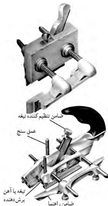
شکل ۳۹-۶- قسمت‌های مختلف رنده کنشکاف.
