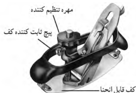
شکل ۴۶-۶- قسمت‌های مختلف رنده کاس و سینه.
