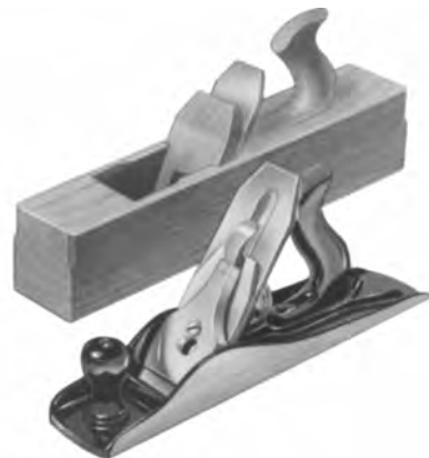
شکل ۶-۵۴- نمونه‌هایی از رنده چوبی و فلزی.
