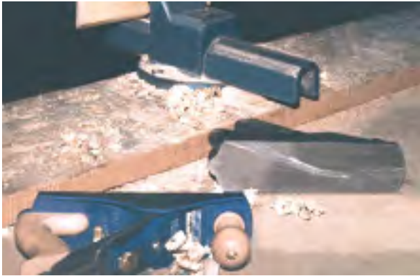
شکل ۶-۹۱- قرار دادن رنده در گودی میز کار.
