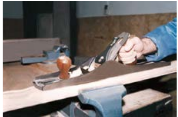
شکل ۶-۸۴- استقرار رنده بلند (دستگاه).
