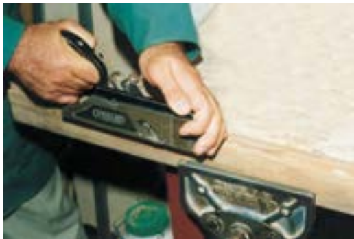
شکل ۶-۷۹. به کارگیری رنده بغل بدون گونیا.
