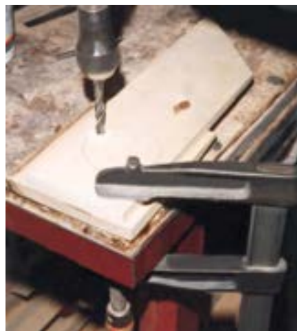
شکل ۵-۵۸- ایجاد سوراخ در قسمت داخلی قطعه کار.
