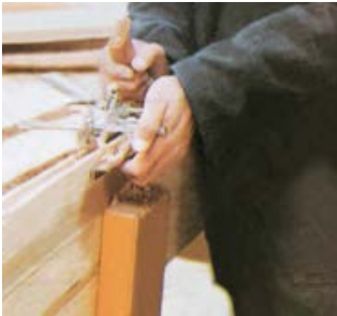
شکل ۸۲-۶- پگونهگی کار با رنده کنشکاف.
