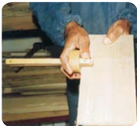
شکل ۶-۷۷. فماتکشی روی چوب با فماتکش تیره‌دار.
