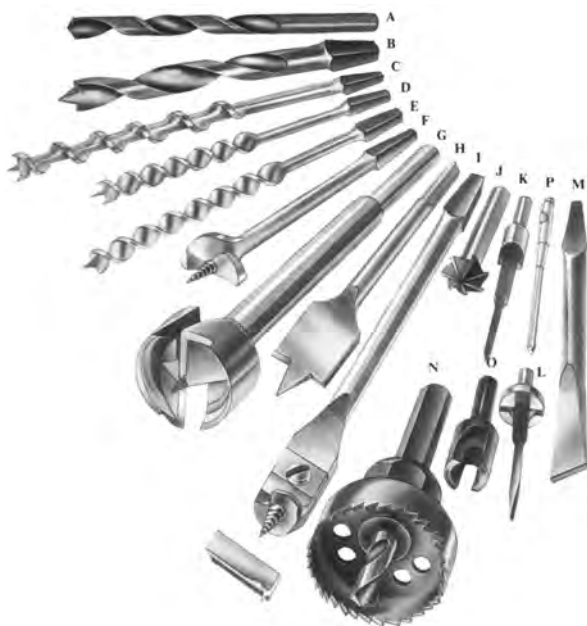
شکل ۱۲-۱۱- انواعی از سر مته‌های مخصوص چوب.
