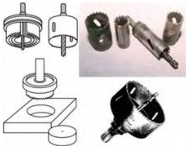
شکل ۱۲-۲۸- سر مته‌ی گردبر و کاربرد آن.
