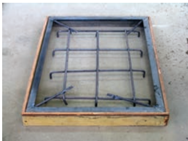
شکل ۵-۱- قرارگیری میل‌گردها در قالب
