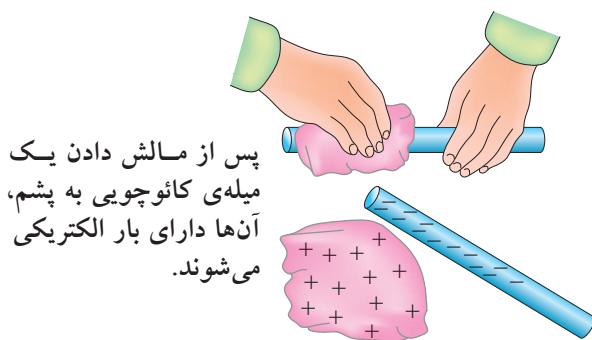
شکل ۱۸-۳- الکتریسته مالشی (اثر تریبو الکتریک)
