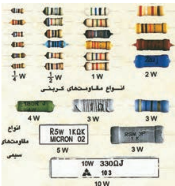
شکل ۱۷-۶- استانداردهای توان در مقاومت ها
