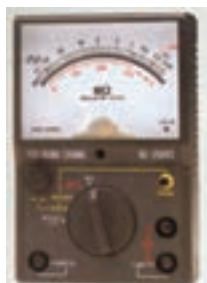
شکل ۲۶-۵ یک نمونه اهم متر آزمایشگاهی
