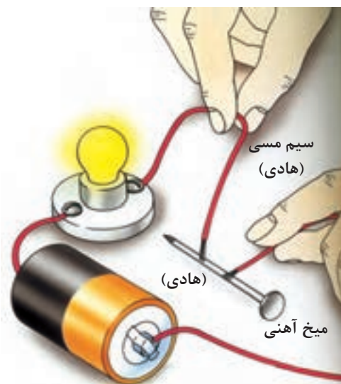
شکل ۲-۳- برقراری جریان الکتریکی در هادی‌ها
