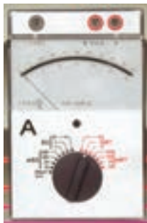
شکل ۲۴-۵ یک نمونه آمپر متر آزمایشگاهی
