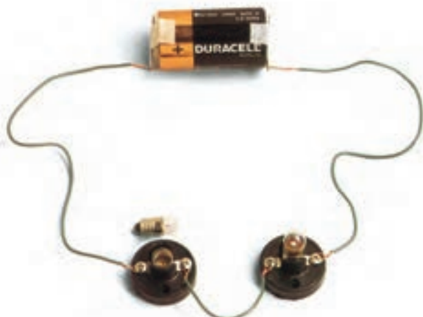
شکل ۵-۲۱- قطع لامپ موجب قطع شدن مدار سری می‌شود.
