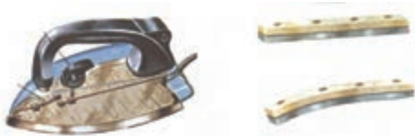
شکل ۳-۲۰- رشته حرارتی اتوی برقی به عنوان مقاومت الکتریکی نقش تولید حرارت و کنترل جریان را به عهده دارد.
