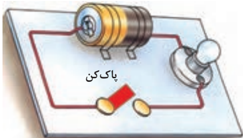
ب - ضریب مقاومت پاک کن زیاد است در نتیجه با وصل به پیچ لامپ روشن نمی شود.
