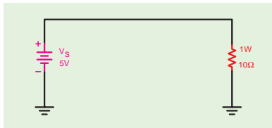
شکل ۱۶-۶ بررسی جریان مصرف کننده براساس توان مجاز
