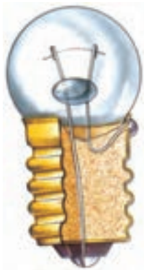
شکل ۹-۱۱۹- بار اهمی خالص که توان حقیقی مصرف می کند.
