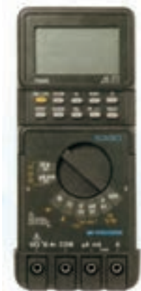
شکل ۳۰-۵ یک نمونه آوومتر دیجیتالی با رنج ظرفیت سنج
