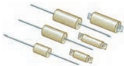
شکل ۸-۳۳- مقاومت نشتی خازن ها در حد مگان اهم است.
