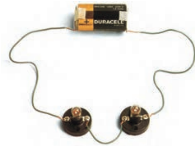
شکل ۵-۳- مدار واقعی دو لامپ به صورت سری
