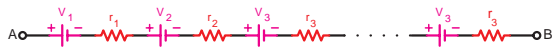
شکل ۵-۱۱۰- اتصال چند پیل به صورت سری با در نظر گرفتن مقاومت داخلی
