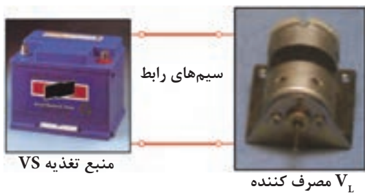
شکل ۵-۹۶ افت ولتاژ بین مولد و مصرف کننده
