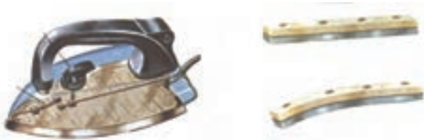
شکل ۲۰-۳- رشته حرارتی اتوی برقی به عنوان مقاومت الکتریکی نقش تولید حرارت و کنترل جریان را به عهده دارد.
