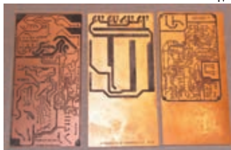
شکل ۷-۶ انتقال مدار چاپی روی فیبر
