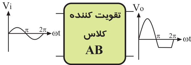
شکل ۳-۵ تقویت کننده کلاس AB
