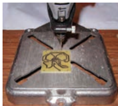
شکل ۷-۸ سوراخ کاری با دریل برقی
