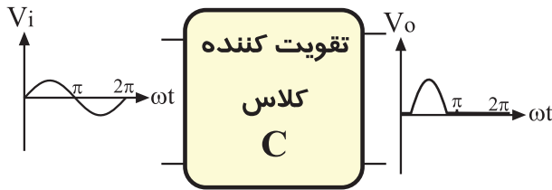
شکل ۳-۶ تقویت کننده کلاس C
