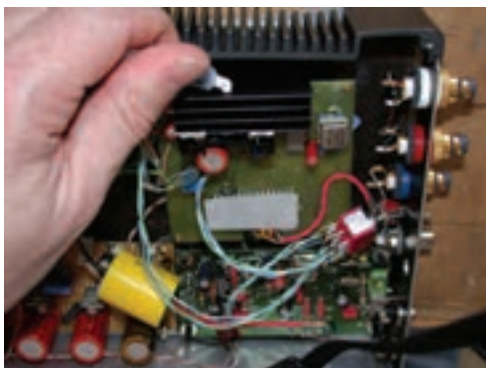
شکل ۷-۱۴ محل نصب هیت سینک
