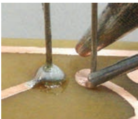
شکل ۷-۱۰ مونتاژ قطعات روی فیبر
