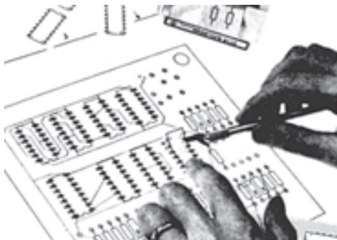
شکل ۷-۳۵ نحوه‌ی چسباندن لتراست مربوط به پایه قطعات
