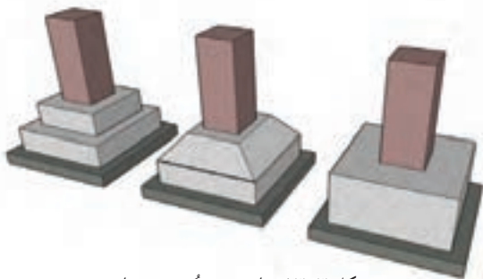
شکل ۳-۵۳ نمایش سه بُعدی پی‌های بتنی مسلح منفرد ساده، هرمی، پلکانی
