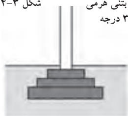
شکل ۳-۴۶ پی بتنی پلکانی با زاویه ۴۵ درجه
