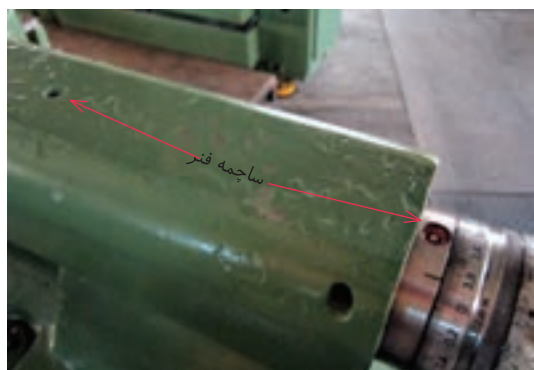
- دهانه ورودی ساچمه فنرها و اطراف آنها را با برس مناسب و پارچه تمیز کنید.
