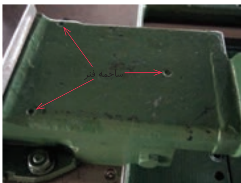
- محل نصب ساچمه فنرهای سوپرت عرضی را شناسایی کنید.
