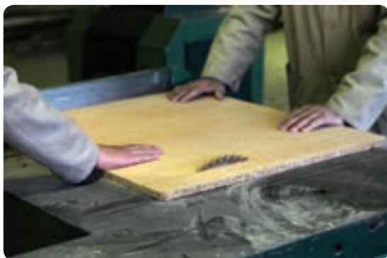
شکل ۶-۷۷ برش در ساده کابینت
