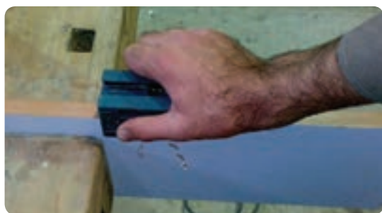
شکل ۶-۸۲ پرداخت لبه اضافی روکش
