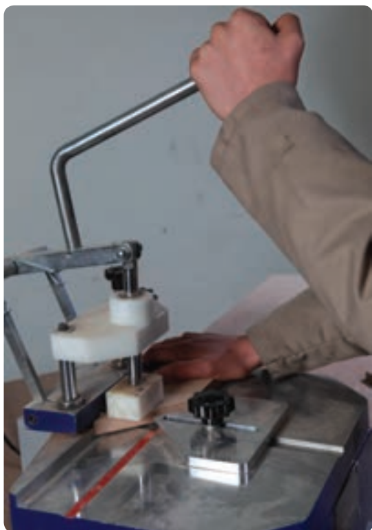
شکل ۹۳-۶ اتصال دم چلچله زن پروفیل
