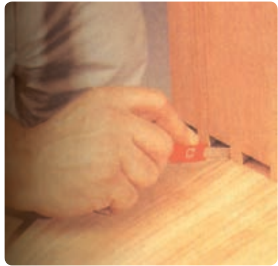
شکل ۶-۱۳۸ خط‌کشی جای فاق روی قطعه دیگر
