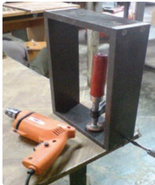
شکل ۶-۱۰۸ مونتاژ دستی جعبه کشو
