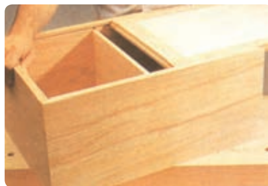
شکل ۱۴۳-۶ قرارگیری پشت بند در کنشکاف بدنه کابینت
