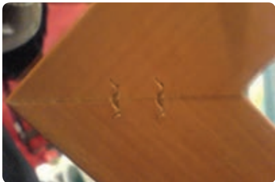
شکل ۹۴-۶ اتصال دوخت قاب
