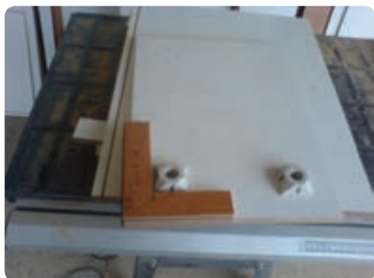
شکل ۶-۱۱۴ شابلون گونیايي جهت نصب پایه کابینت
