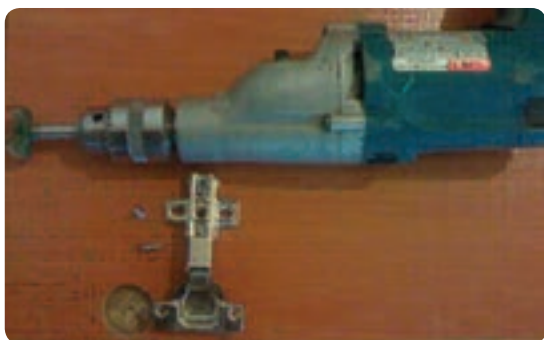
شکل ۱۲۸-۶ نصب لولای کابینت فردار روی در کابینت
