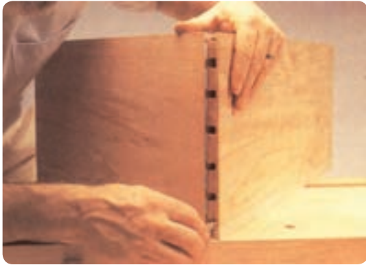
شکل ۶-۱۴۰ مونتاژ آزمایشی قبل از چسب زدن قطعات
