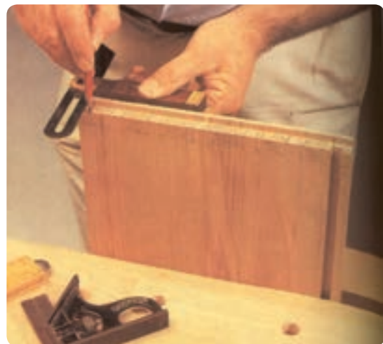
شکل ۶-۱۳۶ خط‌کشی اتصال دم‌چلچله دورو مخفی
