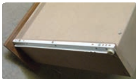
شکل ۶-۱۱۲ نصب ریل مکانیکی در زیر بدنه جعبه
