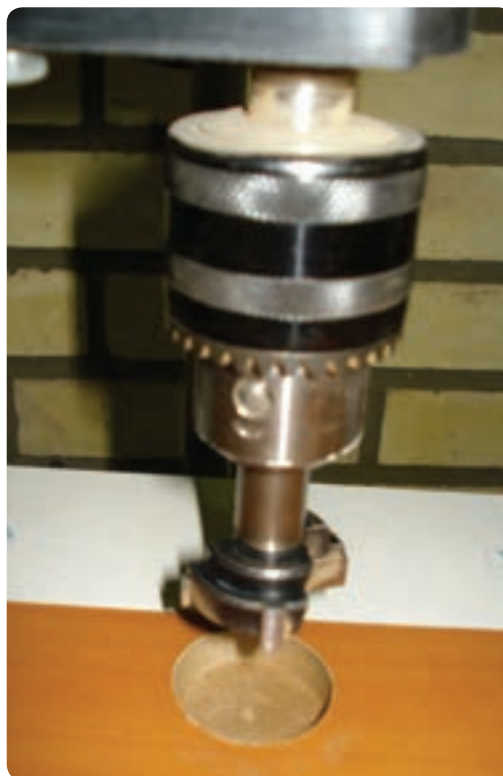
شکل ۶-۷۱ مته کابینت جهت سوراخ کردن جای لولا
