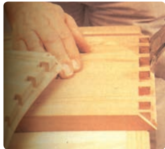
شکل ۶-۱۳۹ برداخت لبه دو راهه شده بدنه کابینت با رنده بغل دو راهه
