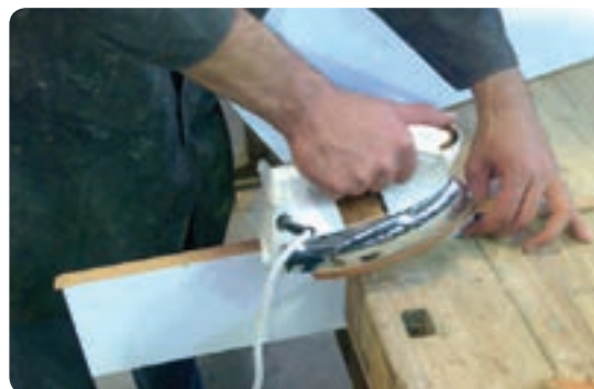
شکل ۶-۸۱ لبه چسبانی روکش مصنوعی با اتو
