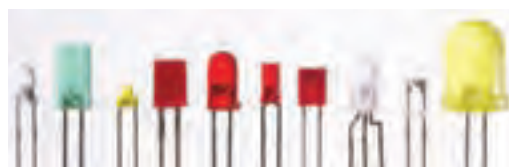
شکل ۲-۲۵ تصویری از چند دیود نورگسیل
