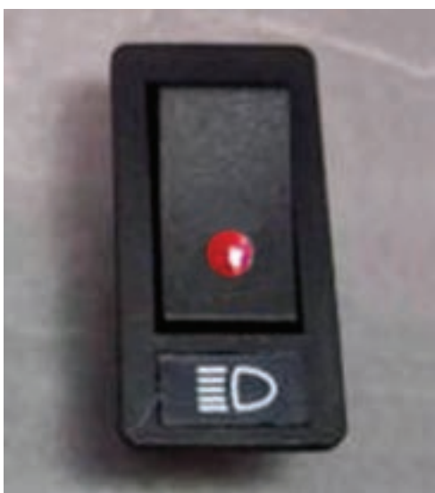
شکل ۸۱-۱- سوئیچ چراغ‌های جانبی (پارک)
