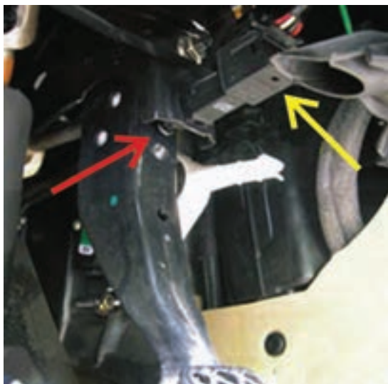
شکل ۱-۷۷- محل نصب سوئیچ مکانیکی ترمز
