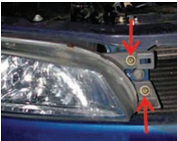
شکل ۱-۴۰- پیچ‌های نگه‌دارنده‌ی چراغ‌های بزرگ جلو
