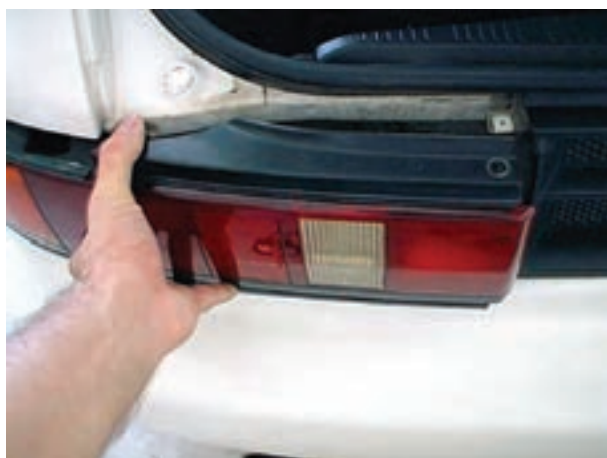
شکل ۱-۵۸- جدا کردن چراغ عقب از بدنه‌ی خودرو
