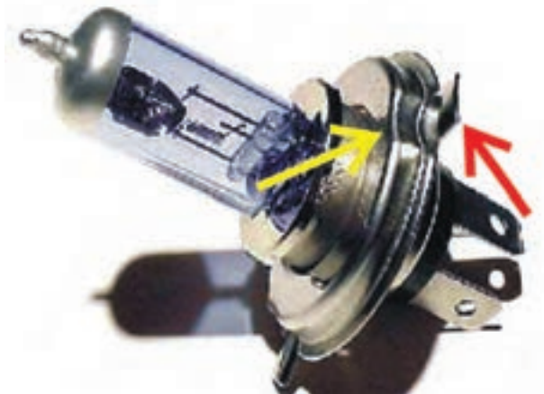
شکل ۲۸-۱ زائده و تورفتگی در ساختمان بدنه‌ی لامپ چراغ بزرگ
