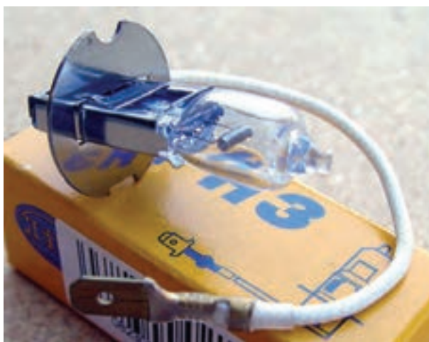
شکل ۱-۳۱- لامپ مورد استفاده در چراغ‌های مه‌شکن، نورافکن‌ها
