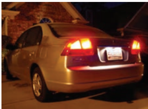
شکل ۲۱-۱- چراغ‌های پلاک خودرو در حالت روشن
