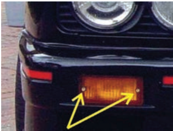
شکل ۱-۵۰ پیچ‌های اتصال تلق چراغ راهنما
