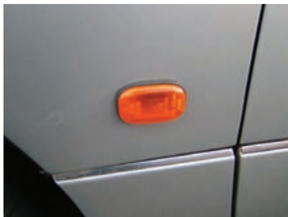
شکل ۱-۶۵- چراغ راهنمای بغل در یک نوع خودرو
