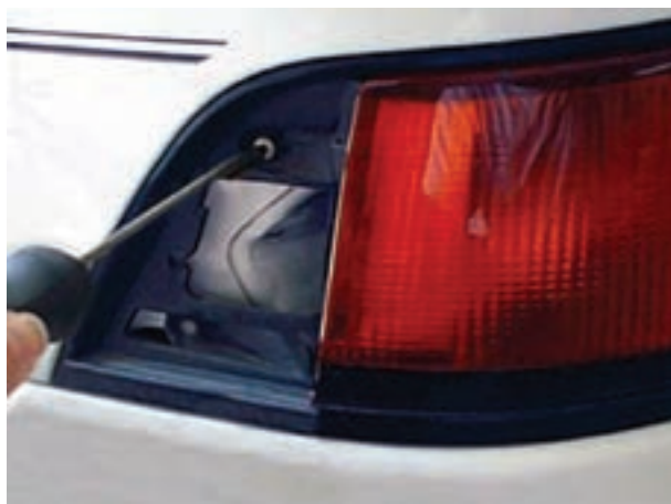
شکل ۱-۵۶- باز کردن پیچ‌های قاب چراغ
