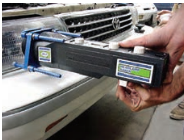
شکل ۱-۱۶۴- نصب هدف گیر به روی بلوری چراغ بزرگ جلو
