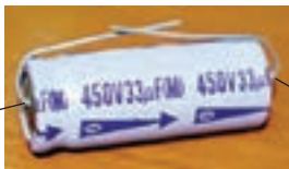
الف - توجه به قطب‌های خازن الکترولیتی
