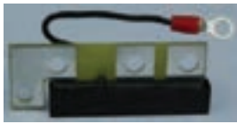
دیودهای مورد استفاده در آلترناتور خودرو
