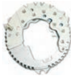
دیودهای مورد استفاده در آلترناتور خودرو
