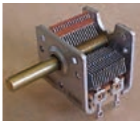
خازن متغیر قابل تنظیم با محور
