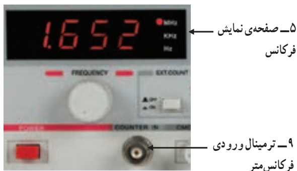
شکل ۱۰۳-۲ فرکانس متر و ترمینال ورودی آن
