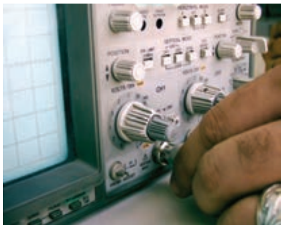
شکل ۱۱۴-۲ نحوه‌ی اتصال BNC به اسیلوسکوپ
