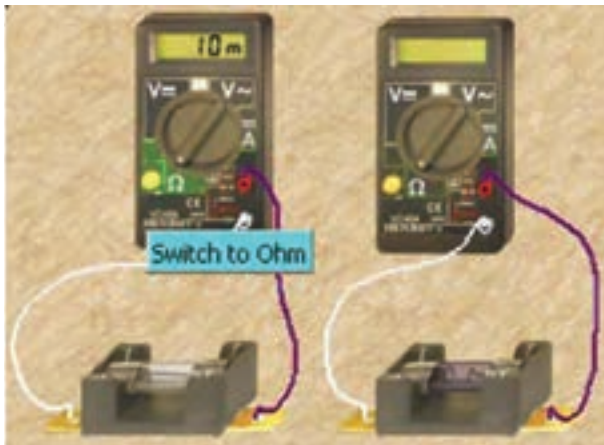
ب - فیوز سوخته است اهم متر مقاومت زیادی را نشان می دهد. الف - فیوز سالم است اهم متر صفر نشان می دهد.
