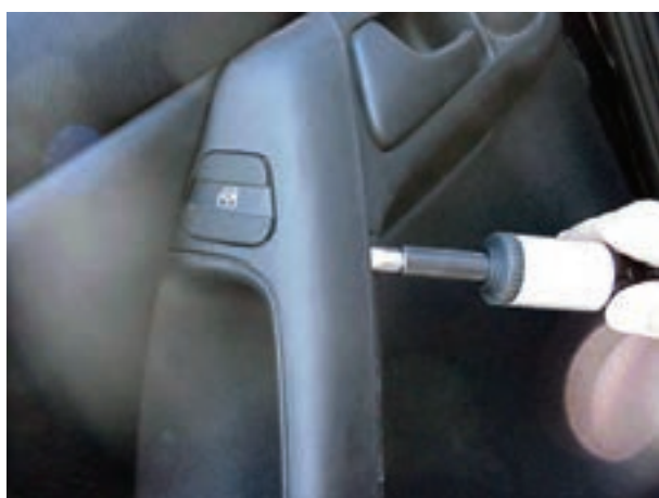
شکل ۲-۱۱۰- جدا کردن قاب سوئیچ شیشه بالابر
