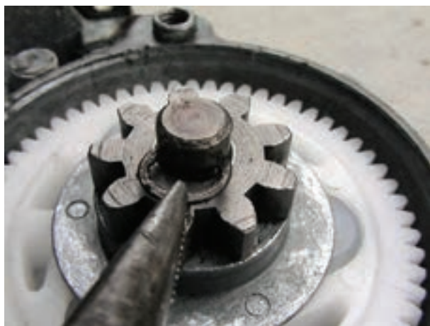
شکل ۱۲۹-۲ جانداختن خار فنری
