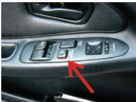
شکل ۱۳۷-۲- سوئیچ قفل کن سیستم شیشه بالابر
