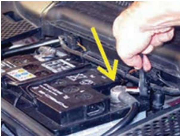
شکل ۱۴۱-۲- باز کردن کابل اتصال بدنه‌ی باتری
