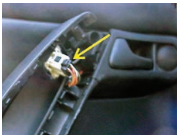
شکل ۲-۱۱۱- سوکت سوئیچ شیشه بالابر
