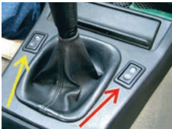
شکل ۱۳۶-۲- سوئیچ شیشه بالابر نصب شده در روی کنسول وسط
