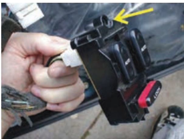
شکل ۲-۱۴۴- محل و پیچ اتصال سوئیچ به بدنه‌ی در
