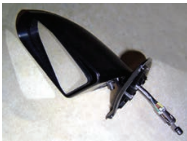
شکل ۱۵۶-۲- آینه‌ی جانبی و مکانیزم حرکت آن
