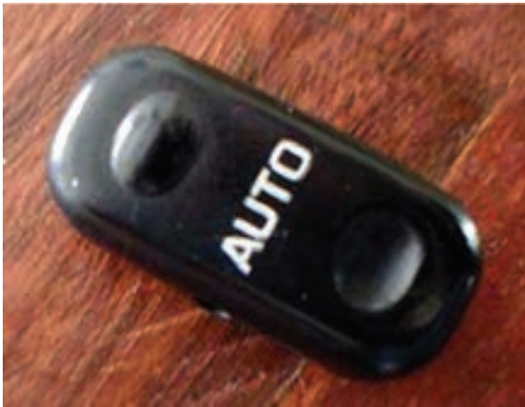
شکل ۱۴۶-۲- شستی سوئیچ شیشه بالابر
