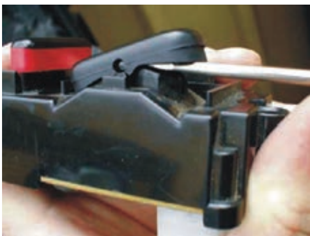
شکل ۲-۱۴۵- تعویض شستی معیوب
