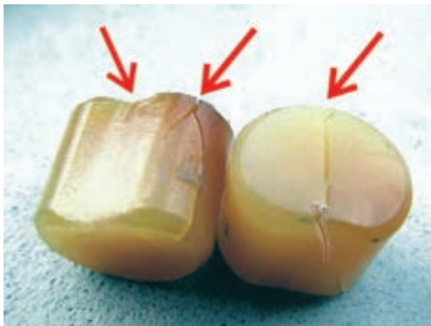
شکل ۱۲۶-۲- معیوب بودن بادامک‌ها
