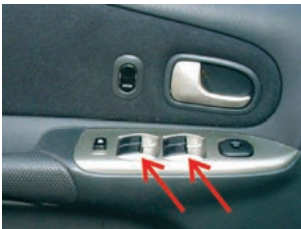
شکل ۱۳۵-۲- سوئیچ های شیشه بالابر در سمت راننده
