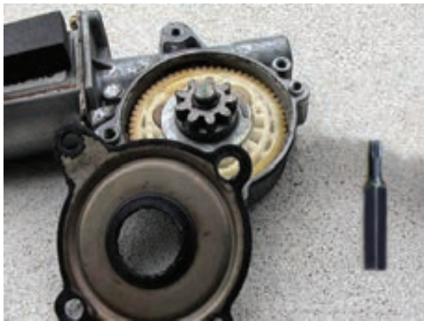
شکل ۱۲۴-۲- اجزای داخل جعبه دنده‌ی تعدیل دور
