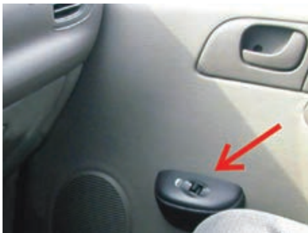
شکل ۱۳۳-۲- سوئیچ شیشه بالابر در جلو سمت سرنشین
