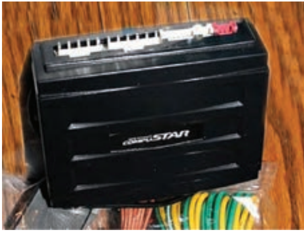
شکل ۵۷-۲- واحد اصلی سیستم دزدگیر
