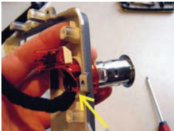
شکل ۲۳۲-۱- خارج کردن فنکدک
