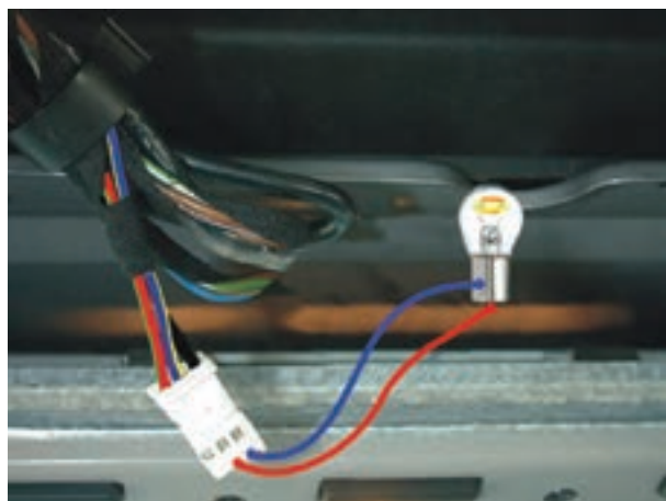
شکل ۱-۲۳۶- آزمایش سیم کشی مدار فندک
