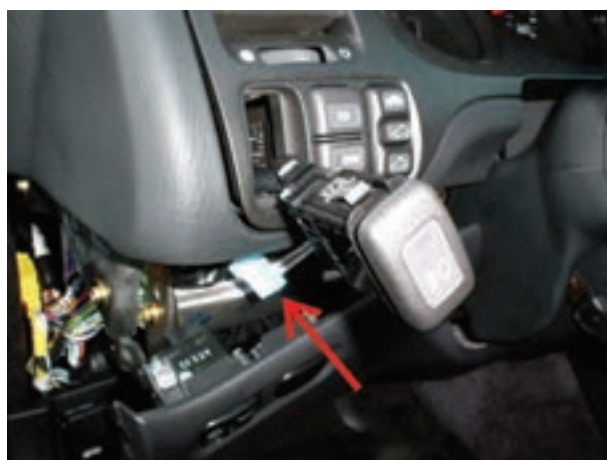
شکل ۱-۸۷- سوئیچ چراغ‌های بزرگ جلو
