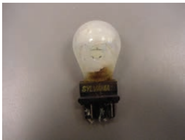
شکل ۱۴۱-۱- اثر عوامل فیزیکی در معیوب شدن لامپ
