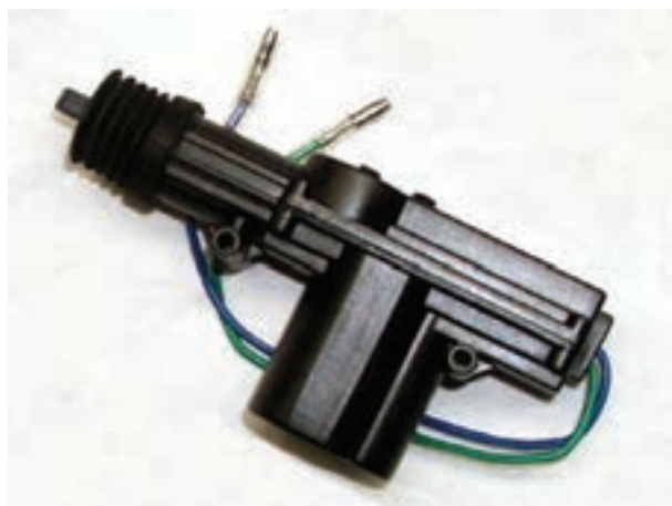
شکل ۲-۲۵- عملگر الکتریکی دو سیمی
