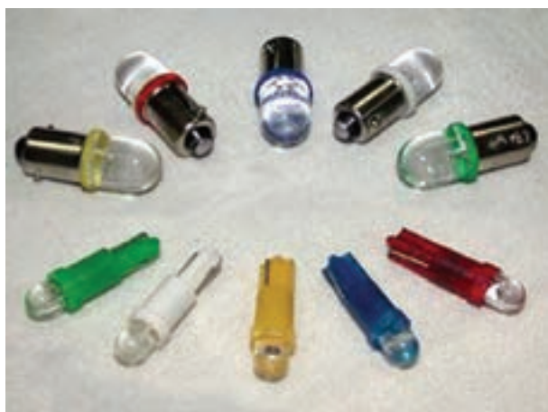
شکل ۲۰۸-۱- دو نوع از لامپ‌های اخطار
