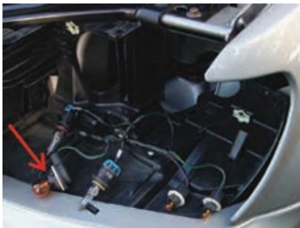
شکل ۱-۵۱ لامپ چراغ‌های روشنایی در یک نوع خودرو
