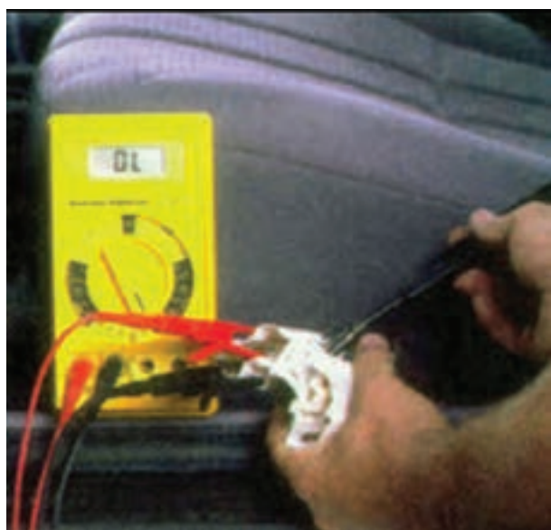
شکل ۹۸-۱- آزمایش حالت استپ موقت دسته ی راهنما
