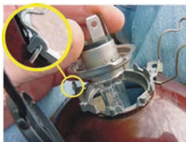
شکل ۱-۴۳- نحوه‌ی ثابت شدن لامپ درون کاسه‌ی چراغ
