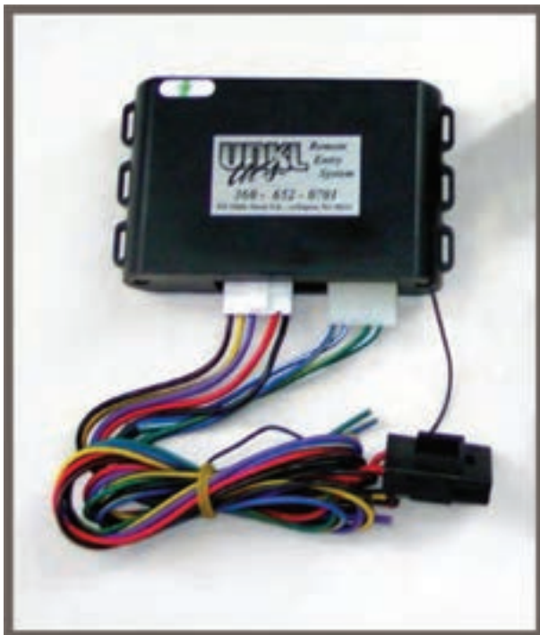
شکل ۲-۵- واحد کنترل الکترونیکی
