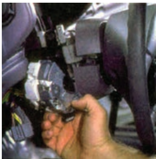
شکل ۹۶-۱- خارج کردن سوئیچ روشنایی از محل خود
