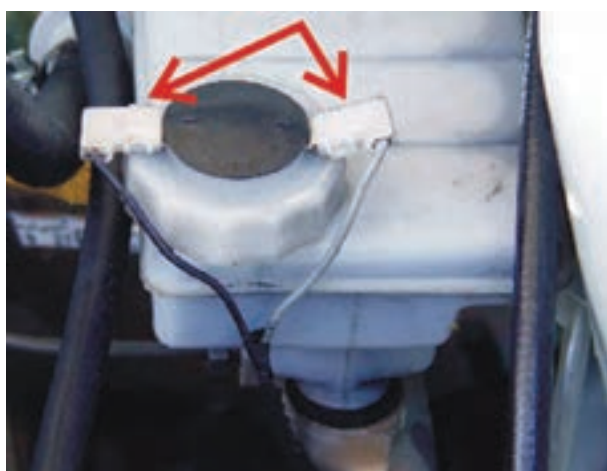
شکل ۲۰۳-۱- سوکت های اتصال پلاتین ها
