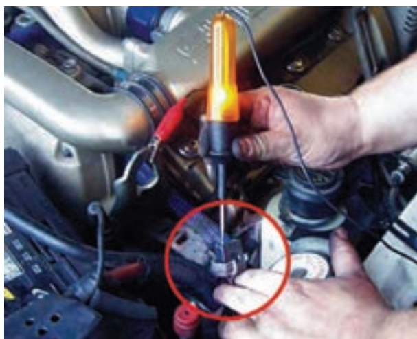
شکل ۱۴۵-۱- آزمایش برقراری جریان مدار چراغ های روشنایی
