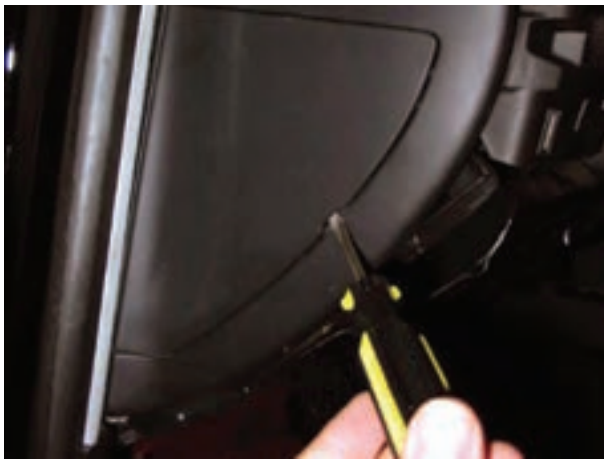
شکل ۱۱۸-۱- آزاد کردن خار پوشش محفظه‌ی جعبه‌ی فیوز
