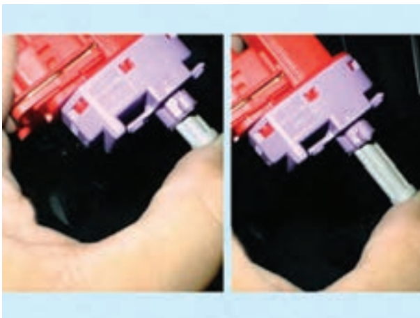
شکل ۱-۱۹۹- عملکرد پلانجر سوئیچ جعبه‌ی داشبورد
