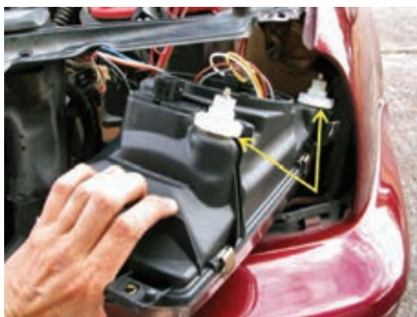
شکل ۱-۱۵۶- اهرم تنظیم کاسه چراغ یک نوع خودرو
