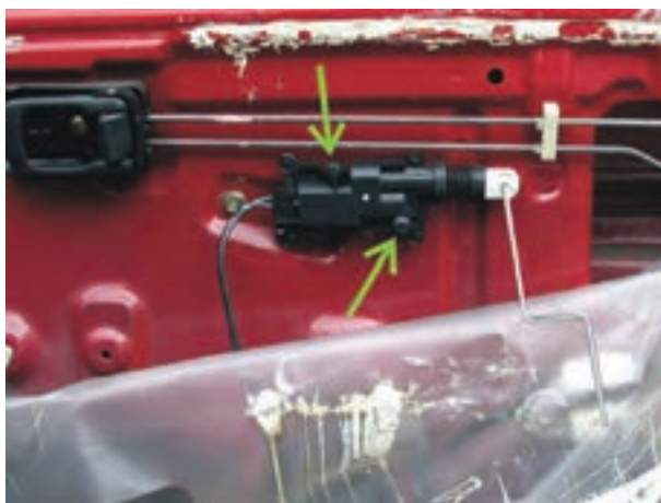
شکل ۲-۲۹ – اتصال عملگر الکتریکی در روی در خودرو
