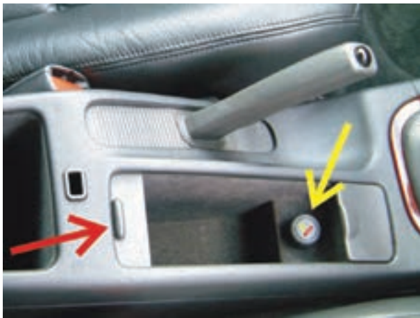
شکل ۱-۲۲۲- فندک یک نوع خودرو
