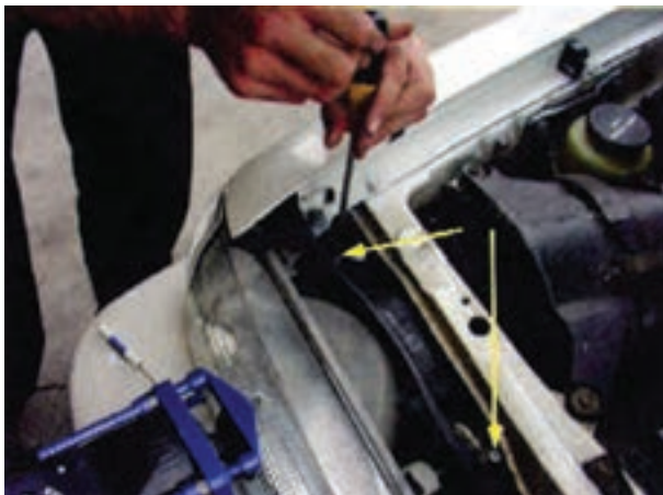
شکل ۱۶۷-۱- پیچ‌های تنظیم چراغ بزرگ جلو
