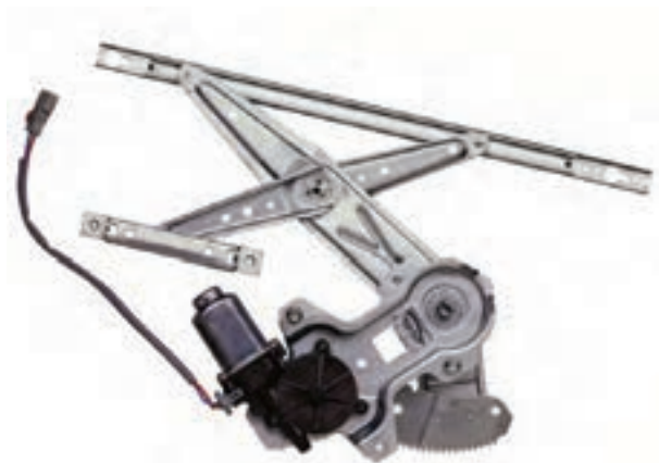
شکل ۲-۹۹- مکانیزم شیشه بالابر یک نوع خودرو
