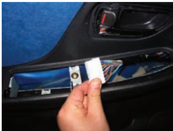
شکل ۱۸۵-۲- سوکت اتصال دسته سیم به سوئیچ‌ها
