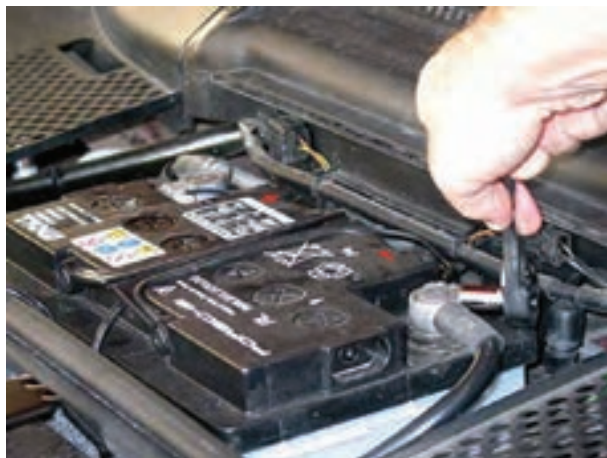
شکل ۲-۳۳- باز کردن اتصال بدنه‌ی باتری
