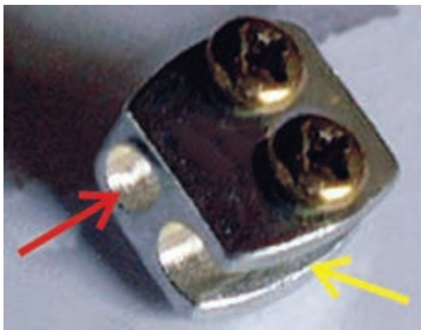
شکل ۲-۱۵- بست مورد استفاده در سیستم قفل مرکزی
