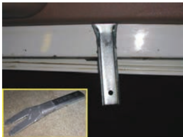
شکل ۲-۳۵- اهرم خاردرآر و نحوه‌ی استفاده از آن
