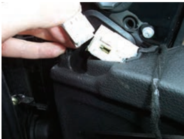
شکل ۱۶۶-۲- جدا کردن سوکت سیم کشی آینه
