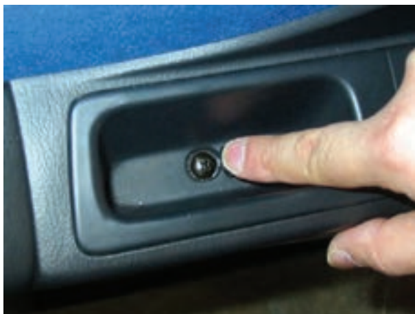
شکل ۱۸۲-۲- پیچ اتصال قاب سوئیچ به بدنه
