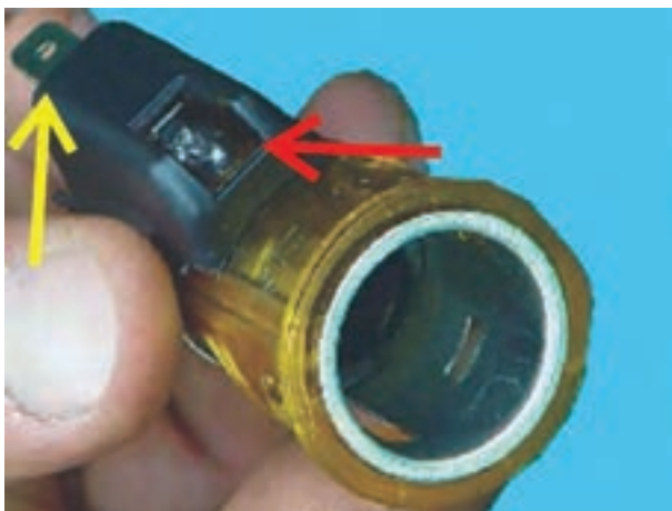
شکل ۱-۲۲۴- لامپ فندک و ترمینال الکتریکی آن
