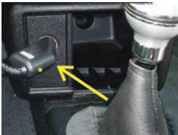
شکل ۱-۲۲۷- استفاده از جافندکی برای شارژ باتری دستگاه تلفن همراه
