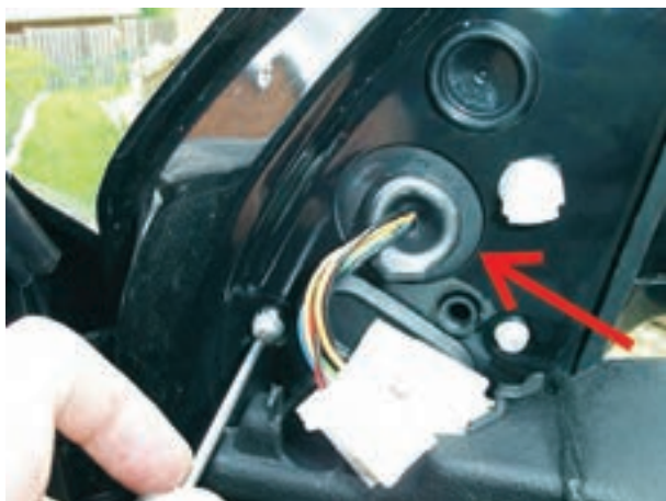
شکل ۱۷۸-۲- باز کردن پیچ نگه دارنده‌ی پایه‌ی اصلی آینه
