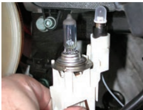
شکل ۱-۴۹ - پایه‌ی مشترک لامپ‌های چراغ روشنایی و پارک
