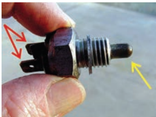
شکل ۱۰۴- پلانجر و ترمینال‌های سوئیچ دنده عقب
