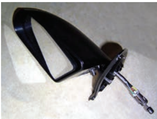
شکل ۱۵۶-۲- آینه‌ی جانبی و مکانیزم حرکت آن
