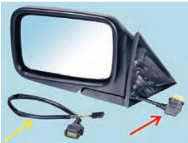
شکل ۱۵۷-۲- آینه‌ی الکتریکی خودرو
