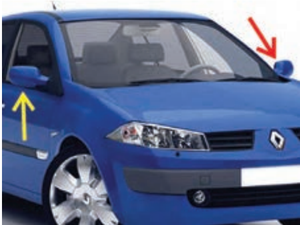
شکل ۱۵۴-۲- آینه‌های جانبی یک نوع خودرو
