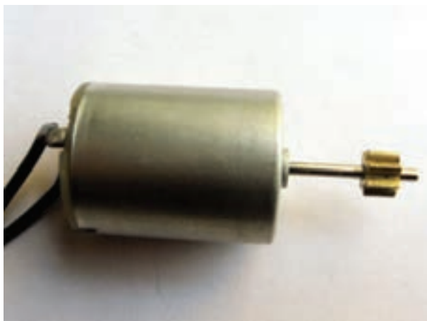
شکل ۲-۱۷- موتور الکتریکی عملگر
