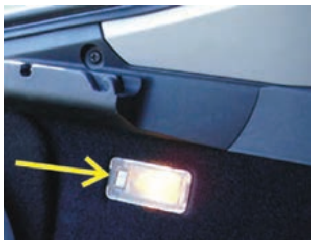
شکل ۲۱۸-۱- چراغ صندوق عقب و سوئیچ روی آن
