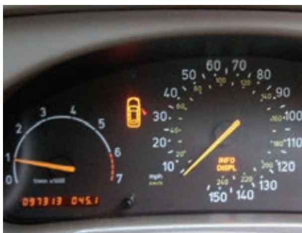
شکل ۲۱۳-۱- چراغ اخطار بازبودن درهای خودرو
