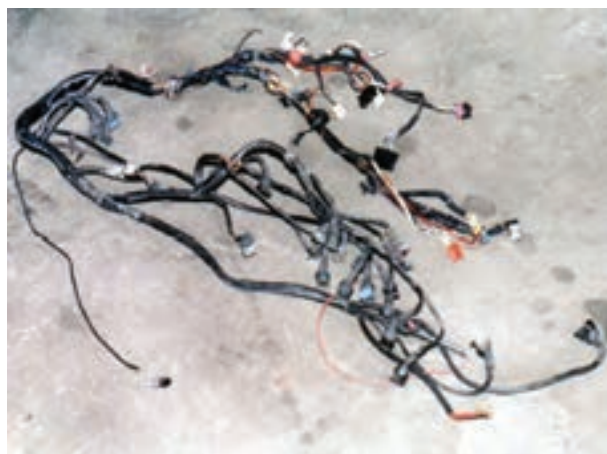
شکل ۱۳۳-۱- دسته‌ی سیم‌های یک نوع خودرو
