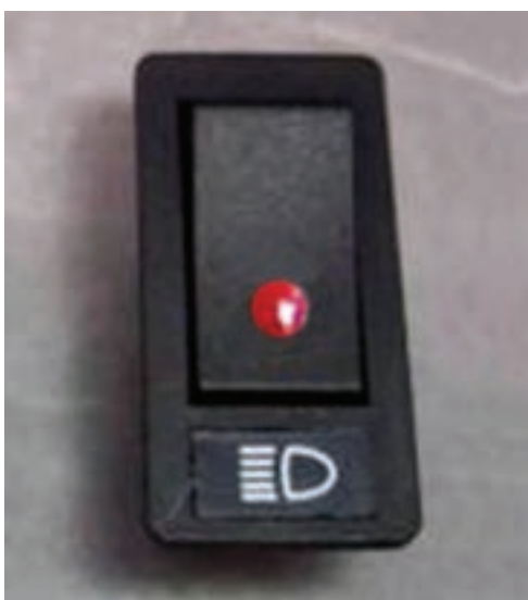
شکل ۸۱-۱- سوئیچ چراغ‌های جانبی (پارک)
