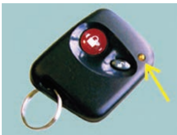
شکل ۲-۷- دیود نوری روی قاب ریموت کنترل
