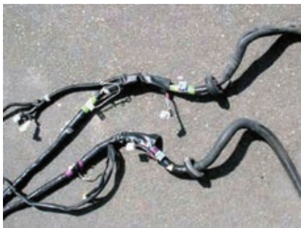
شکل ۱-۱۳۷- کلاف سیم کشی یک نوع خودرو
