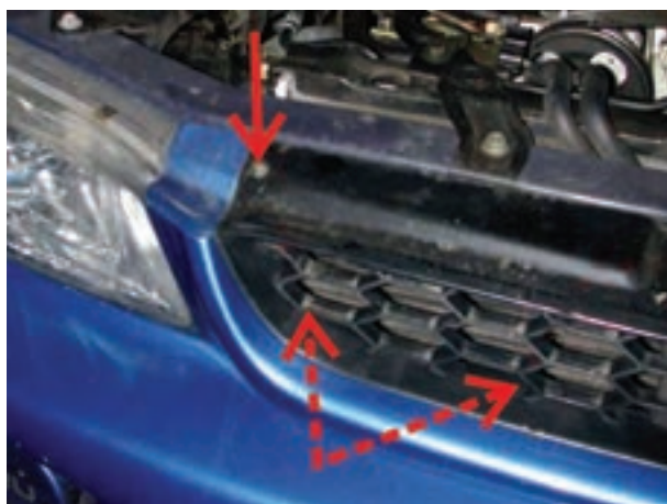
شکل ۳۶-۱- محل قرار گرفتن بیج‌های اتصال جلوی پنجره به شبکه‌ی فلزی جلوی خودرو
