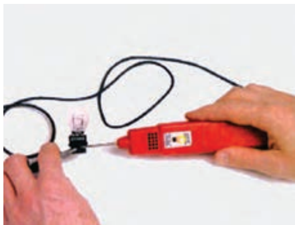
شکل ۲۱۹-۱- آزمایش لامپ چراغ صندوق عقب خودرو
