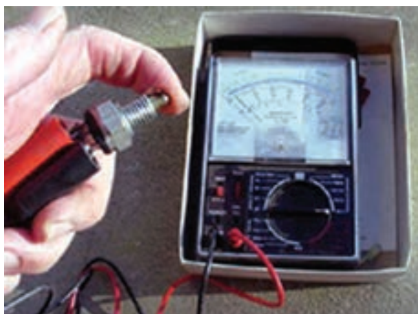
شکل ۱۰۵-۱- آزمایش سوئیچ چراغ‌های دنده عقب
