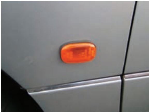
شکل ۱-۶۵- چراغ راهنمای بغل در یک نوع خودرو
