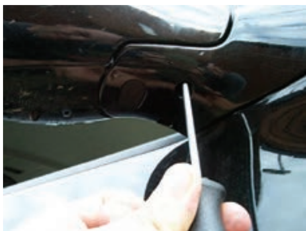
شکل ۱۷۶-۲- بازکردن پیچ روی پایه ی بیرونی آینه
