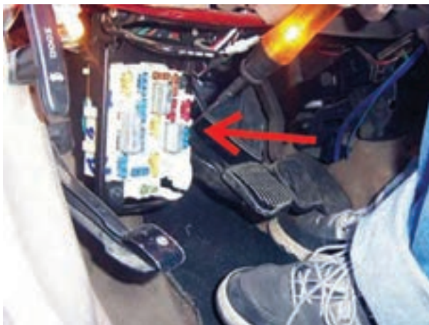
شکل ۱۲۰-۱- آزمایش جعبه‌ی فیوز با چراغ آزمایش
