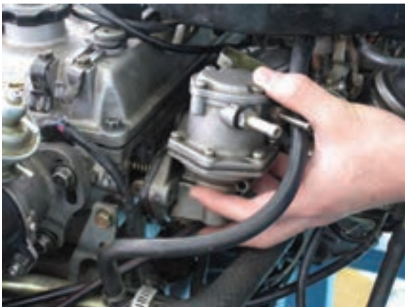
شکل ۱-۴۴ الف: نصب پمپ
