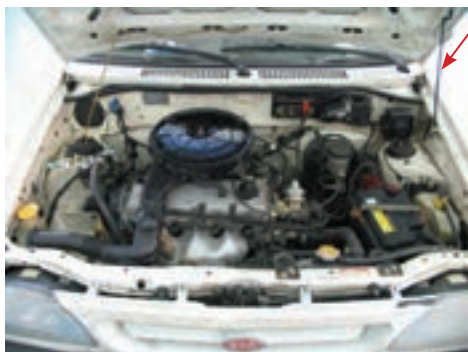
شکل ۱۱۹- ۱ نصب صحیح اهرم نگه‌دارنده درپوش موتور خودرو
