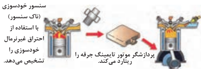
شکل ۲-۲۰ کنترل بازخورد تایمینگ جرعه
