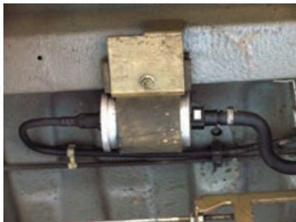
شکل ۱-۴۷ بست‌های دوطرف فیلتر سوخت
