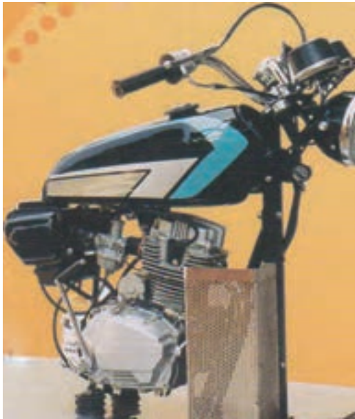
شکل ۱-۳۵ مدار سوخت‌رسانی موتور سیکلت
