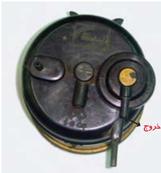
شکل ۱-۹۷ شیر خروجی سوخت‌های دمای تبخیر شده از کنیستر
