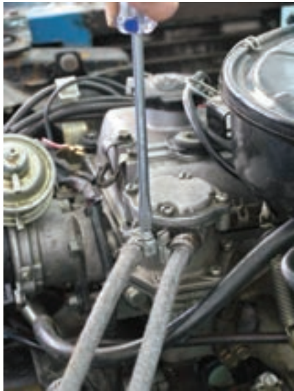
شکل ۱-۳۲ اتصال لوله سوخت به پمپ
