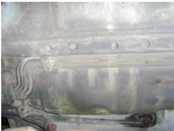
شکل ۱-۳۳ لوله سوخت از مخزن تا پمپ
