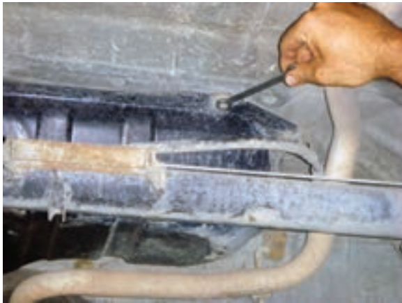
شکل ۱-۲۵ باز کردن پیچهای دور باک
