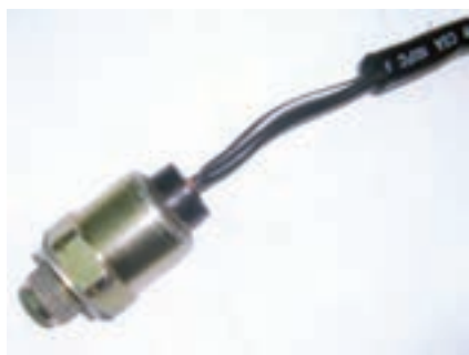
شکل ۱-۹۲ سلونوئید مدار دور آرام
