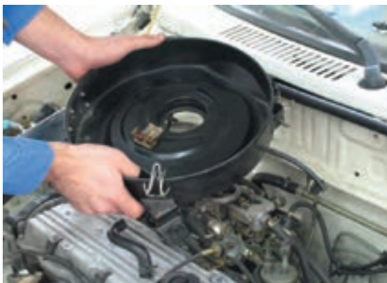
شکل ۱۰۰-۱ پیاده کردن مجموعه هواکش
