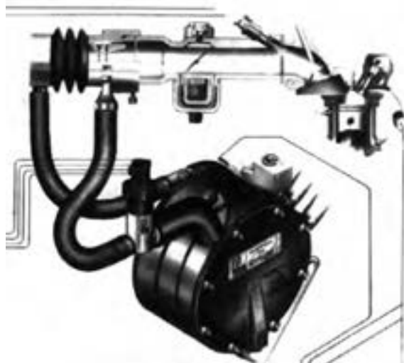
شکل ۱۵-۱- سیستم مخلوط کننده سوخت گاز با هوا
