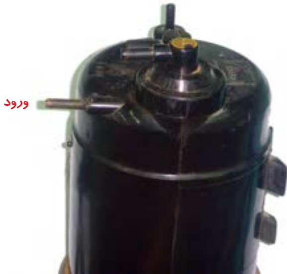
شکل ۱-۹۶ شیر ورودی سوخت‌های تبخیر شده به کنیستر
