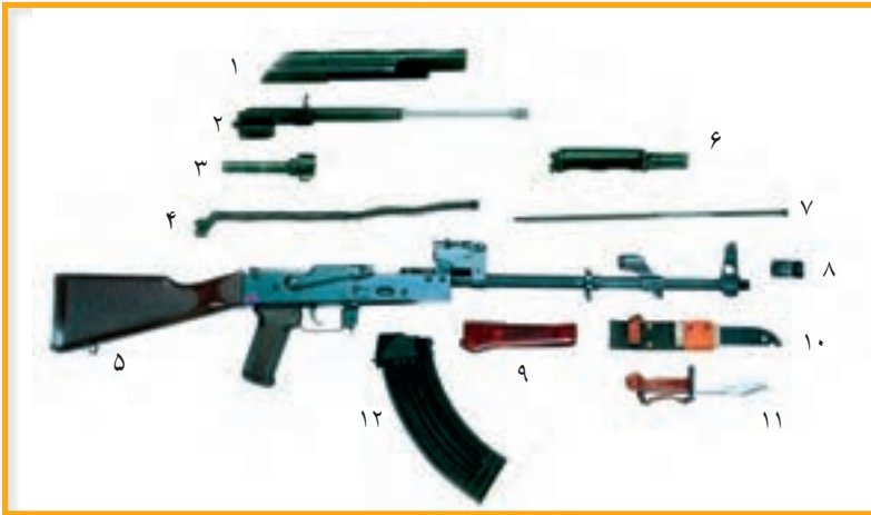
قطعات بازشدهٔ اسلحه کلاشینکف
