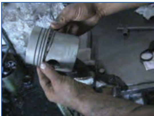
شکل ۱۳۸-۴- جا زدن رینگ با دست
