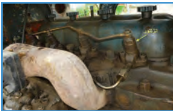
شکل ۳۲-۲- انژکتورهای تراکتور U650M
