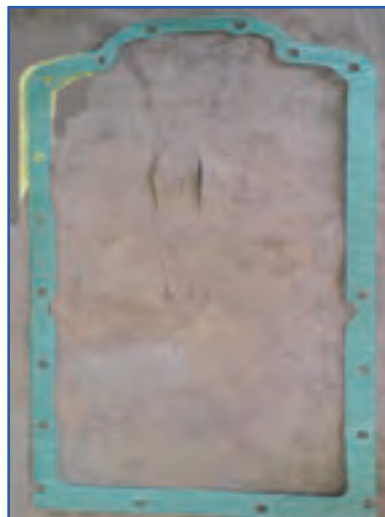
(ب) واشر کارتر چوب‌بنبه‌ای MF285
