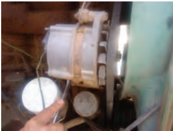
شکل ۳۹-۶ سفت کردن پیچ پایه
