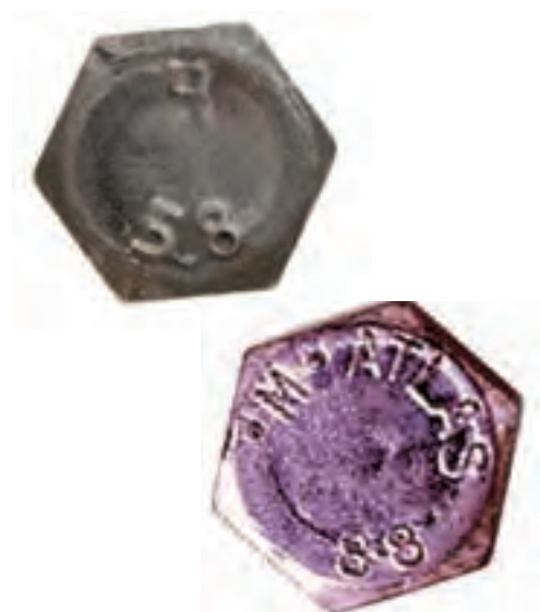
شکل ۱۵-۳ اعداد حک شده روی سر پیچ
