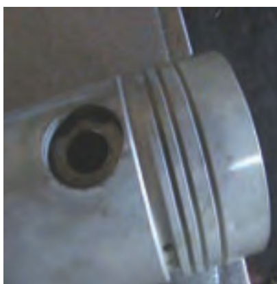
شکل ۱۲۳-۴ میزان داخل شدن انگشتی در پیستون
