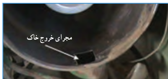
شکل ۱۱-۵ محل خاکدان در تراکتور جاندیر
