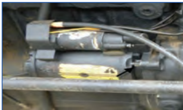
شکل ۳-۸- پیچ های نگهدارنده استارت تر تراکتور MF285
