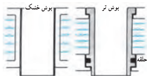
ب) محل قرار گرفتن اورینگ ها روی بوش تر
