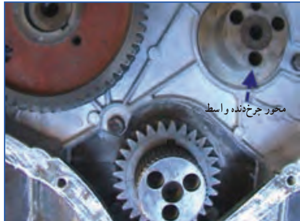
شکل ۶۷-۴ چرخ‌دنده واسط برداشته شده است.
