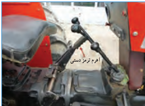
شکل ۱۹-۲- ترمز دستی تراکتور
