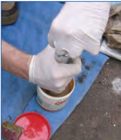
شکل ۴۸-۷- مراحل پیر کردن گریس پمپ دستی
