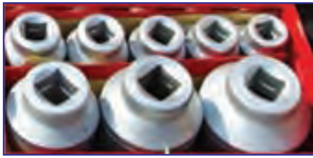
شکل ۳۹-۳- انواع شکاف چهار گوش (درایوبکس) آچار بکس
