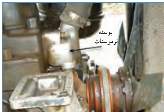
شکل ۳۷-۲ پوسته ترموستات تراکتور U650
