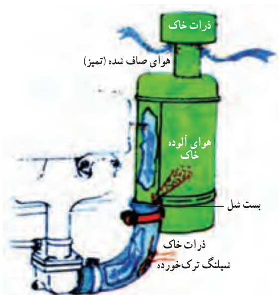
شکل ۱۹-۵- محل بریدگی و سوراخ شدگی در شیلنگ‌ها
