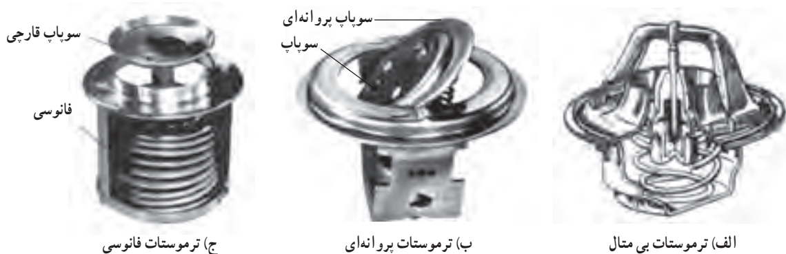
شکل ۱۹-۳- انواع ترموستات
