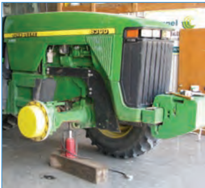
شکل ۱۱-۴- قرار دادن جک روغنی زیر جسم سنگین
