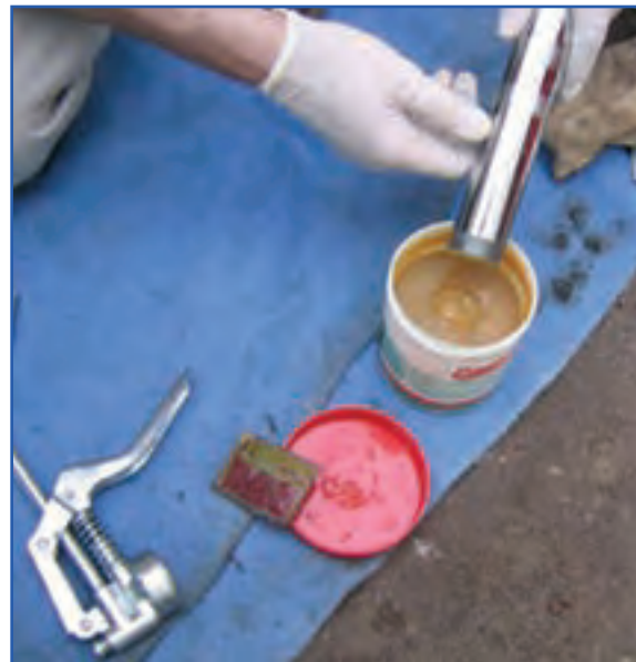
شکل ۴۸-۷- مراحل پیر کردن گریس پمپ دستی
