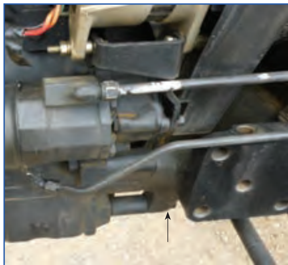
شکل ۱۷-۳- محل پیچ‌های اتصال موتور به جلوی تراکتور
