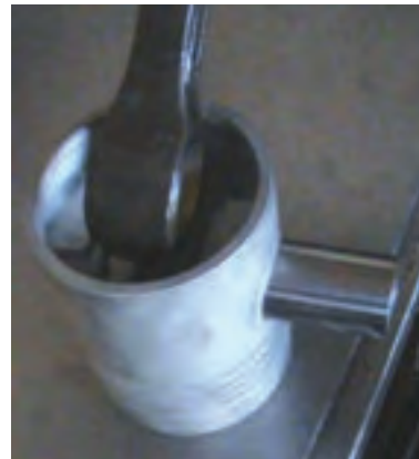
شکل ۱۲۲-۴ اتصال شاتون به پیستون و جازدن انگشتی
