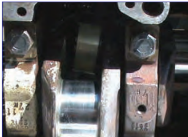
شکل ۲۰۱-۴- هدایت شاتون روی میل لنگ
