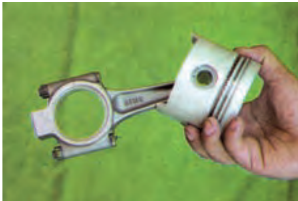
شکل ۱۲۶-۴- طرز آزمایش لقی شاتون روی انگشتی
