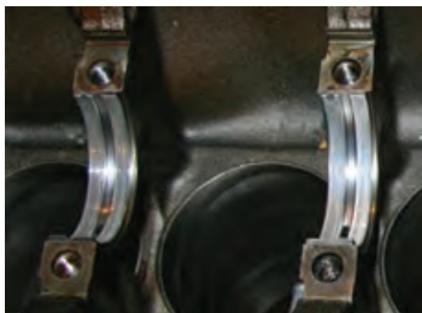
شکل ۱۸۵-۴ جازدن یاتاقان‌های ثابت
