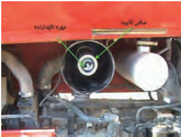
(ب) محل قرار گرفتن صافی ثانویه
