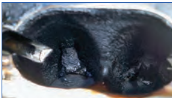
الف) کربن محفظه پشت سوپاپ‌ها
