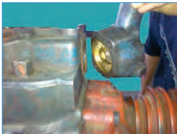
شکل ۲۱-۳- باز برداشتن درپوش ترموستات بعد از باز کردن پیچ‌های آن در تراکتور U650M
