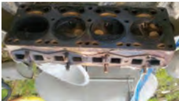
شکل ۲۰۹-۴- رسوبات کربن سطح سرسیلندر
