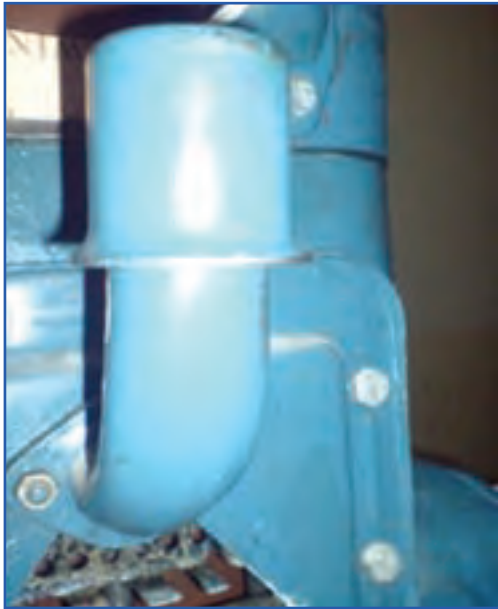
شکل ۲۹-۷- هواکش روغن U650M
