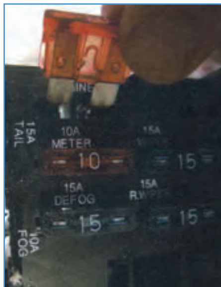
شکل ۶۹-۶- جازدن فیوز در محل آن
