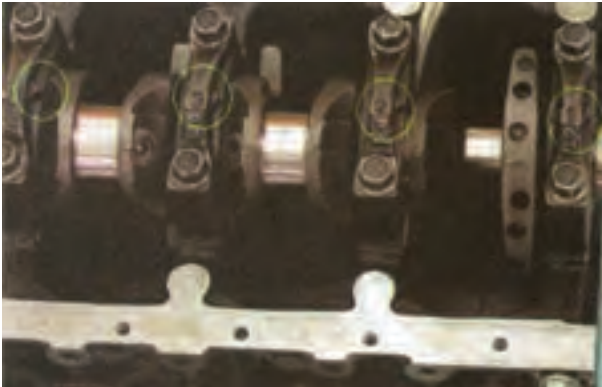
شکل ۱۵۱-۴- علامت زدن روی یاتاقان‌های ثابت
