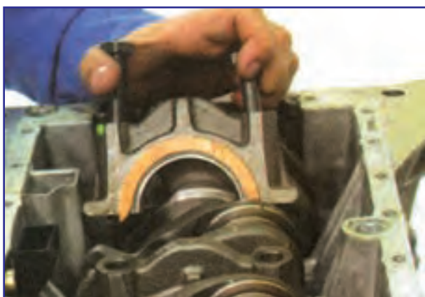
شکل ۱۸۱-۴- برداشتن کپه یاتاقان دارای بغل یاتاقانی
