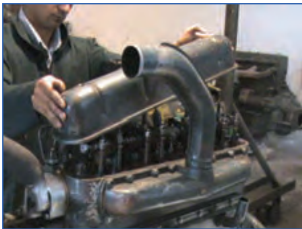
شکل ۴۰-۷- برداشتن قالباق سوپاپ
