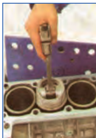
شکل ۱۲۷-۴- طرز قرار دادن رینگ داخل سیلندر
