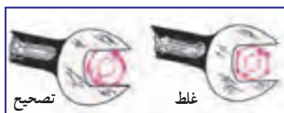
شکل ۲۹-۳ طرز درگیر کردن آچار تخت با مهره
