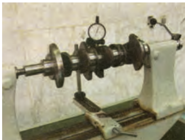
شکل ۱۶۰-۴- دستگاه اندازه‌گیری تاب میل‌لنگ
