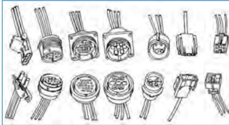
شکل ۵۹-۶ چند نمونه از فیش‌های مورد استفاده در تراکتورها
