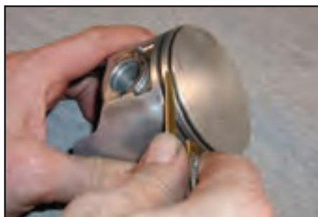
(د) تمیز کردن شیپار با ابزار برنجی
