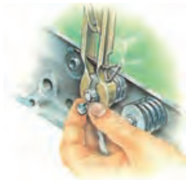
شکل ۱۸-۴- نحوه خارج کردن خار سوپاپ
