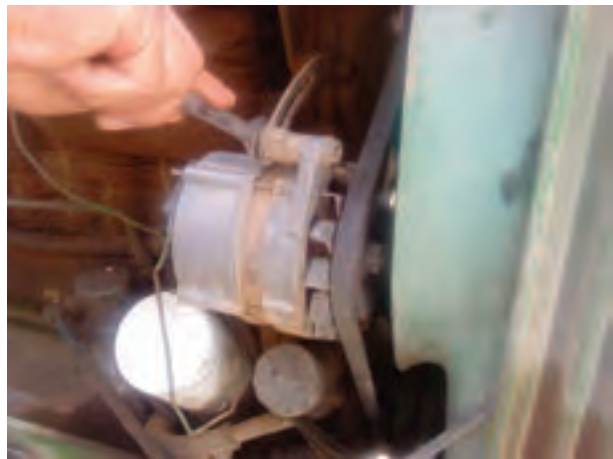
شکل ۳۸-۶ سفت کردن پیچ تنظیم آلترناتور
