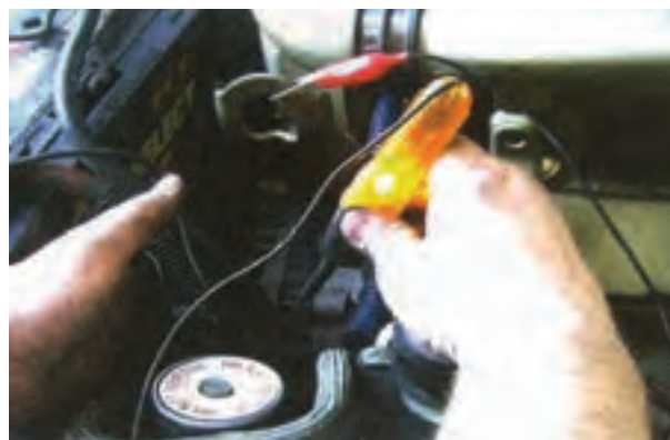
شکل ۷۷-۶- اتصال لامپ آزمایش به مدار
