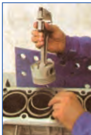
شکل ۱۲۷-۴- طرز قرار دادن رینگ داخل سیلندر
