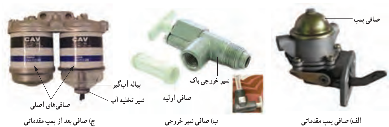
شکل ۹-۴- انواع صافی گازوئیل
