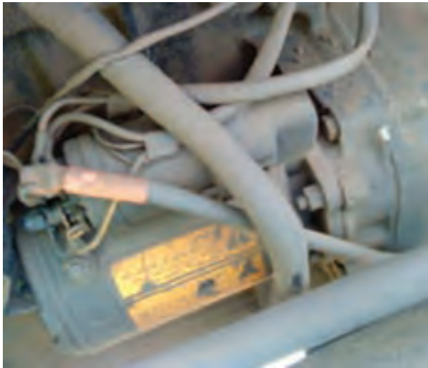
شکل ۶-۴۳- اتصال سیم‌ها از دینام به آفتمات
