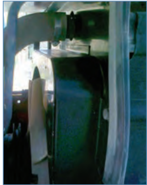
شکل ۳۲-۳- محل بادگیر رادیاتور در تراکتور MF399
