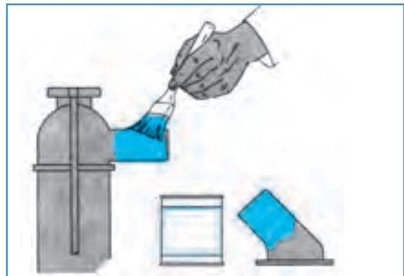
(الف) جرب کردن لوله‌های رادیاتور
