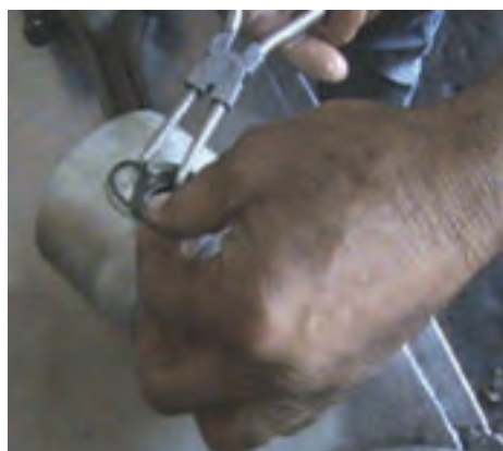
شکل ۱۲۵-۴ طرز جازدن خار انگشتی
