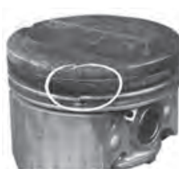
شکل ۴-۹۹- شکستن رینگ و تخریب جای رینگ
