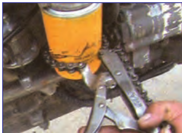
شکل ۱۶-۷- باز کردن صافی روغن با آچار مخصوص
