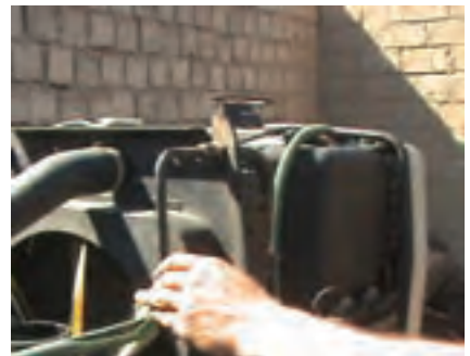
د) باز کردن لوله خنک کن روغن
