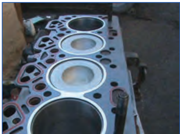
شکل ۵۲-۴- قرار دادن واشر سرسیلندر روی بدنه سیلندر
