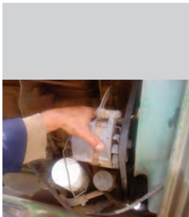
شکل ۳۷-۶ عقب کشیدن آلترناتور
