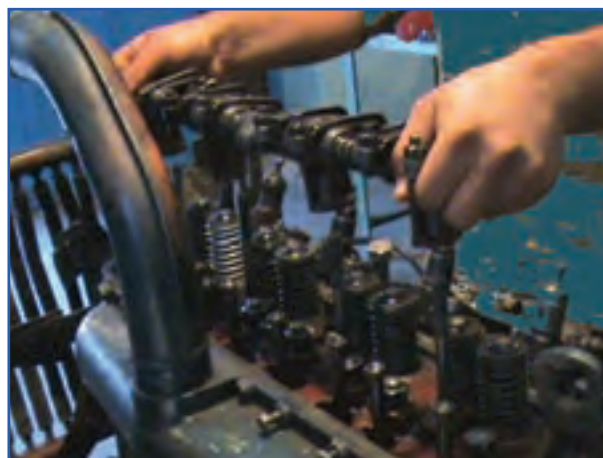
شکل ۹-۴- برداشتن محور اسبک و اسبک‌ها تراکتور U650
