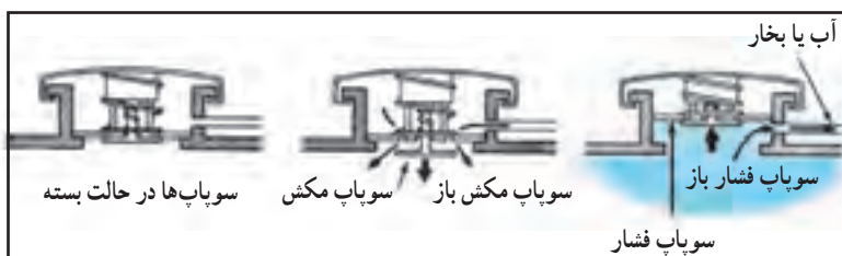
الف) وضعیت سوآپ‌های در رادیاتور
