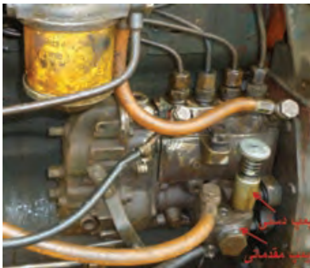
شکل ۸-۴ محل قرار گرفتن پمپ دستی روی پمپ انژکتور
