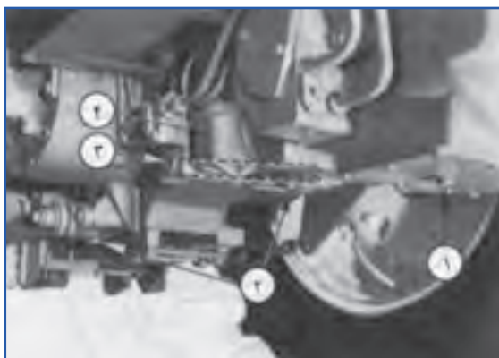
شکل ۶۰-۷- محل قرار گرفتن درجه‌های تخلیه روغن و صافی هیدرولیک در تراکتور JD3140
