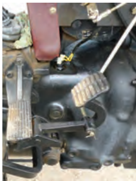
شکل ۱۱-۳- پیچ‌های اتصال موتور به جعبه‌دنده قسمت پایین
