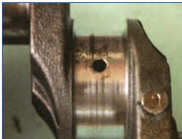
شکل ۱۶۳-۴- میل لنگ با محور معیوب
