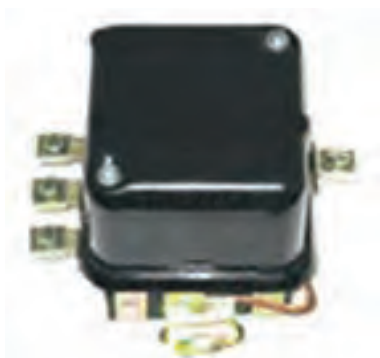
ب) آفتامات جدا از آلترناتور تراکتور U650
