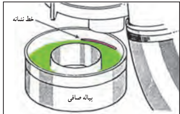
شکل ۱۸-۵- محل علامت روی پاله صافی
