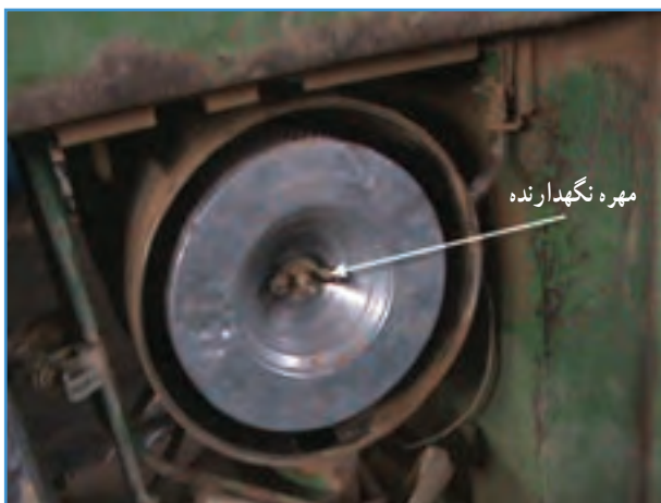
شکل ۱۰-۵ باز کردن شبکه بغل
