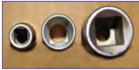
شکل ۳۹-۳- انواع شکاف چهار گوش (درایوبکس) آچار بکس
