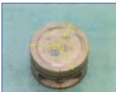
شکل ۱۳۵-۴- زاویه قرار گرفتن رینگ ها نسبت به هم
