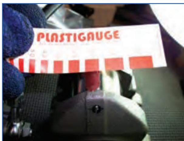
شکل ۱۷۶-۴- اندازه گیری دو بهنی پلاستی گیج شابلون
