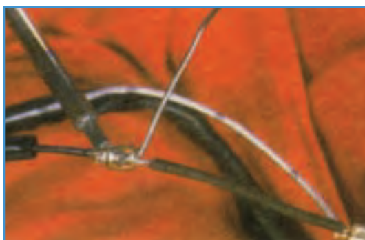
شکل ۶-۶۴- نحوه لحیم کاری سیم‌ها
