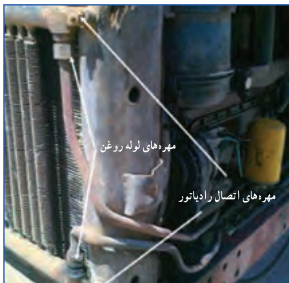
شکل ۳۸-۷- مهره های لوله روغن سمت رادیاتور روغن
