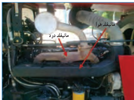
شکل ۲۷-۲- مانیفولد هوا و دود تراکتور MF399
