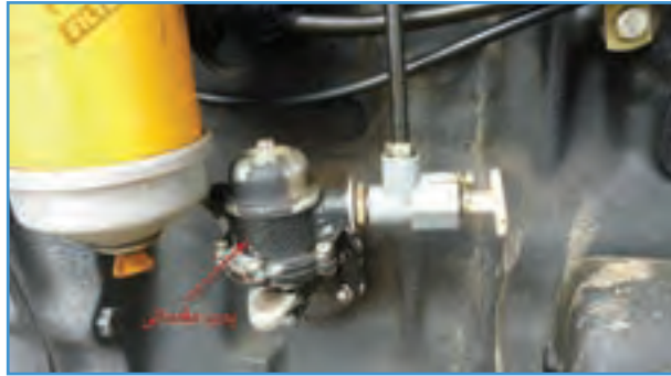
شکل ۲۹-۲- پمپ مقدماتی تراکتور MF285
