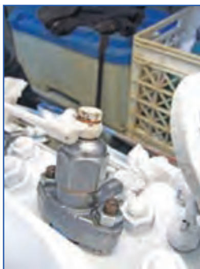
شکل ۵۴-۴- مراحل بستن انژکتور
