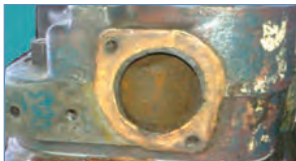
شکل ۲۳-۳ - واشر ترموستات قبلی
