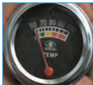
شکل ۱۰-۲- درجه نشان‌دهنده دمای آب
