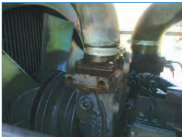
شکل ۱۱-۳- محل بست شیلنگ محفظه ترموستات
