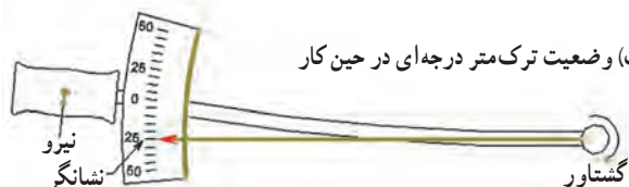
شکل ۳-۵۵- ترک متر درجه‌ای
