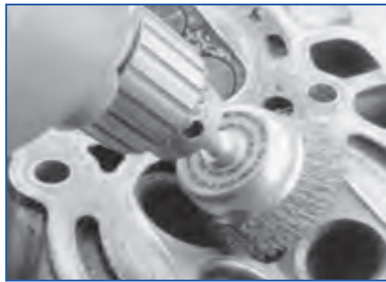
شکل ۴۱-۴- تمیز کردن اتاق احتراق
