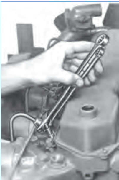
شکل ۲۲-۴- باز کردن لوله‌های فشارقوی انژکتورها
