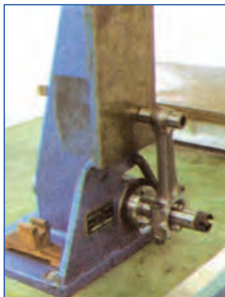
شکل ۱۱۳-۴- ساختمان و طرز نصب شاتون روی فیکسچر
