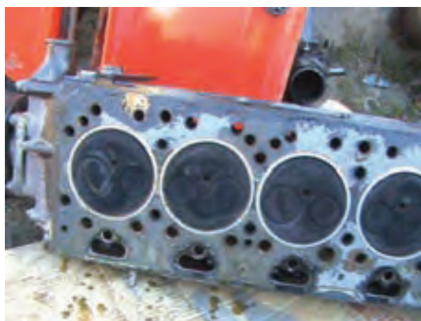
شکل ۱۵-۴- طرز قرار دادن سرسیلندر روی سطح صاف
