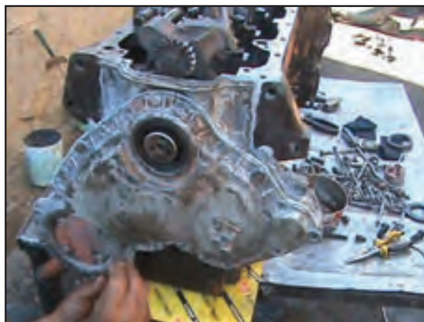
شکل ۴-۵۹- باز کردن پیچ و مهره‌های اطراف سینی جلو
