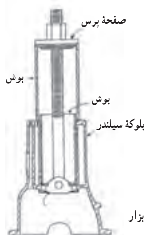
شکل ۱۴۳-۴- نحوه پیاده کردن بوش سیلندر
