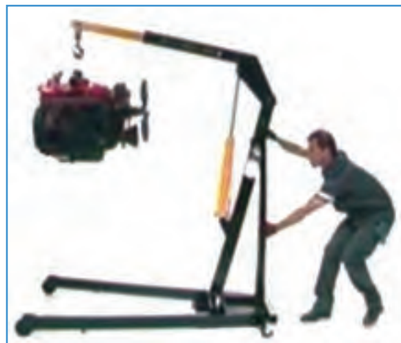
شکل ۱۸-۴- کاربرد از جرثقیل متحرک دستی
