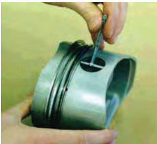
شکل ۱۱۷-۴- اندازه‌گیری سوراخ انگشتی روی پیستون
