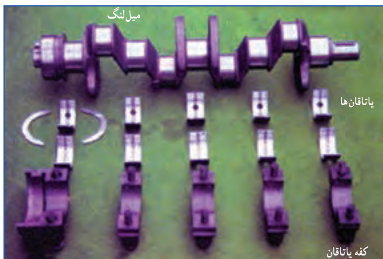
شکل ۳۹-۲- میل‌لنگ، یاتاقان‌ها و کفه یاتاقان‌های ثابت
