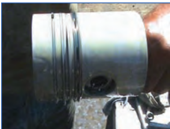
شکل ۱۴۰-۴- روغن‌کاری همه رینگ‌ها و پیستون
