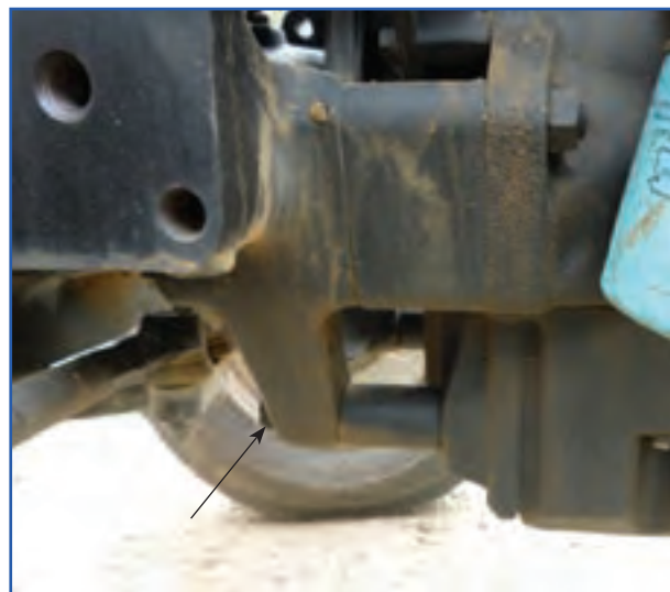
شکل ۱۷-۳- محل پیچ‌های اتصال موتور به جلوی تراکتور
