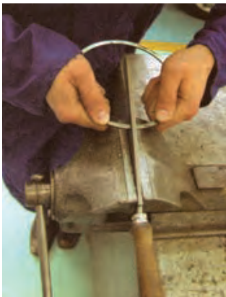
شکل ۱۳۰-۴- ساییدن دهانه رینگ با سوهان
