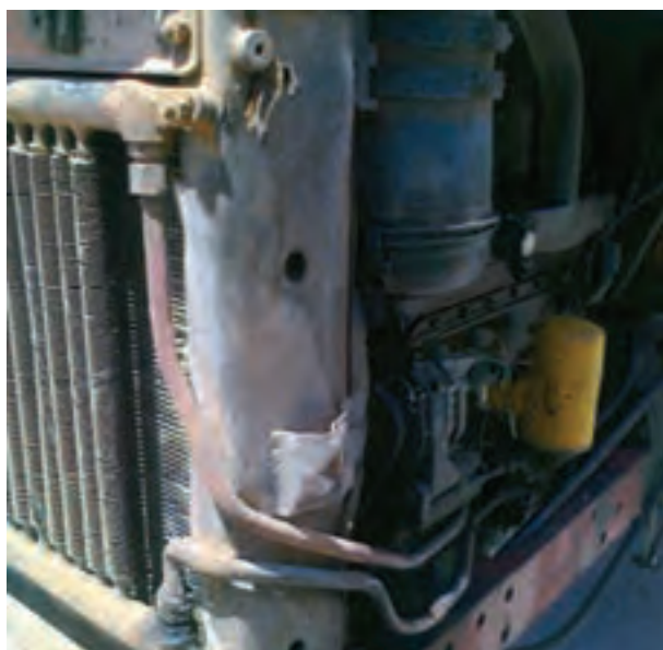
شکل ۱۲-۳- محل مهره‌های رادیاتور روغن
