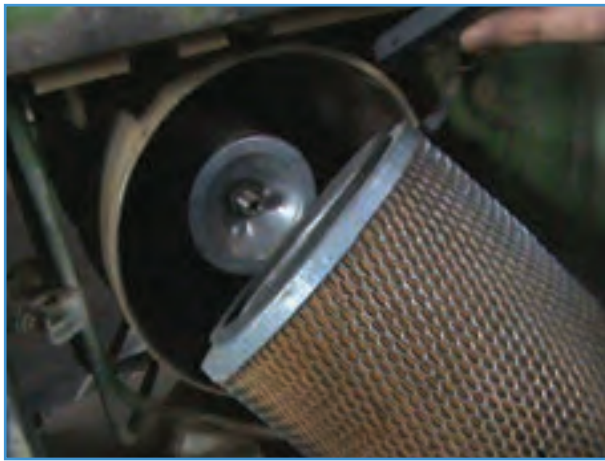
شکل ۵-۵ - صافی خشک و محل قرار گرفتن آن
