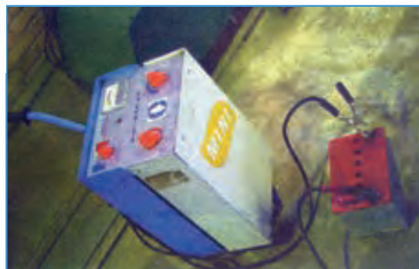
شکل ۱۸-۶ اتصال کابل‌های شارژر به باتری
