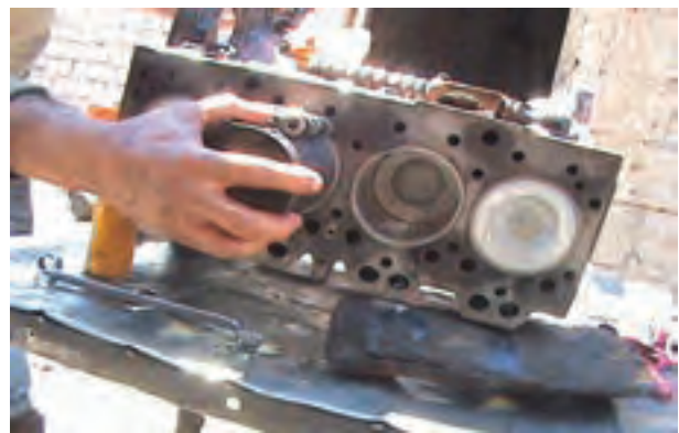
شکل ۱۹۹-۴- چسباندن رینگ جمع کن به سیلندر
