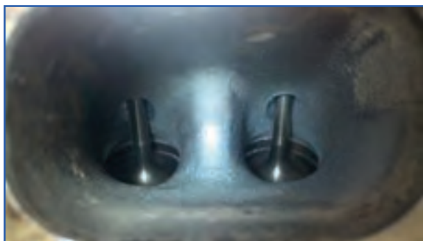
ب) محفظه تمیز پشت سوپاپ‌ها
