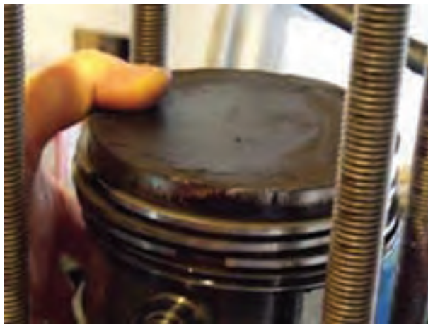
شکل ۲۰۷-۴- رسوبات کربن روی سطح پیستون
