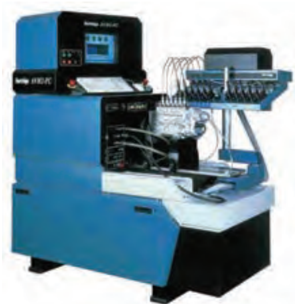
شکل ۲۴-۴- دستگاه آزمودن و تنظیم پمپ انژکتور
