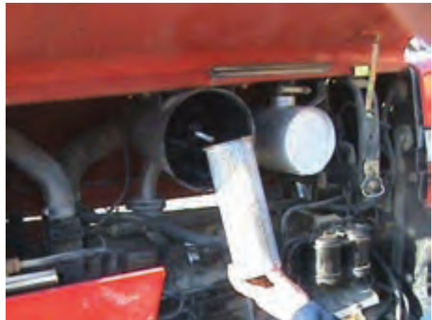
(الف) خارج کردن صافی ثانویه
