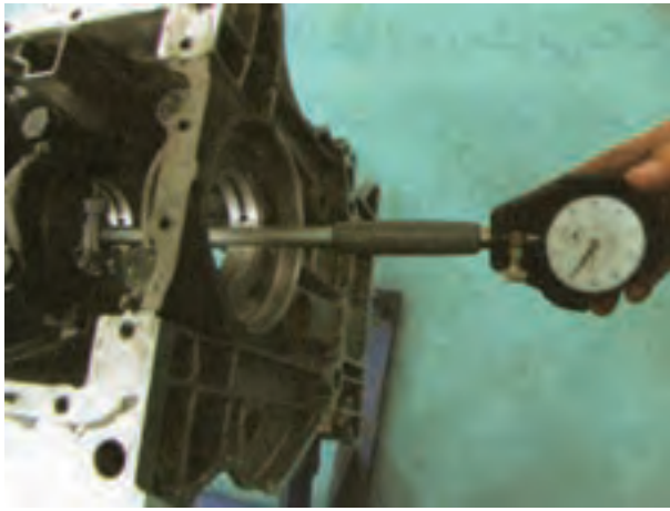
شکل ۱۷۲-۴ اندازه‌گیری قطر داخلی یاتاقان با ساعت اندازه‌گیری
