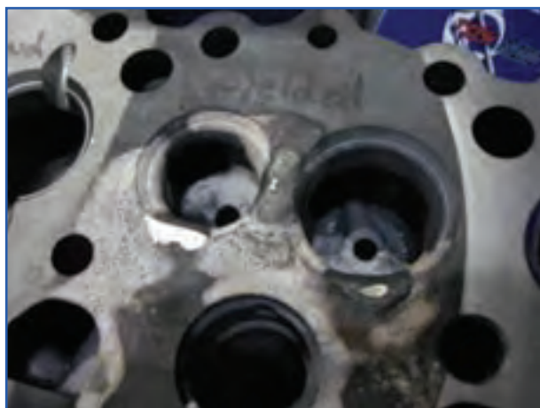
شکل ۲۶-۴- ترمیم ترک سرسیلندر با جوشکاری
