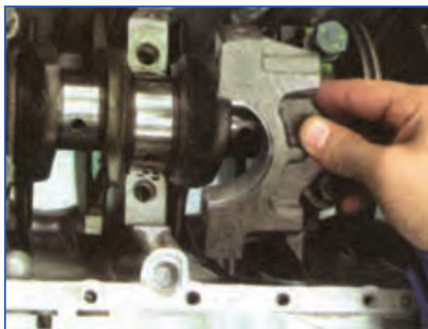
شکل ۱۸۹-۴ - جازدن کپه یاتاقان
