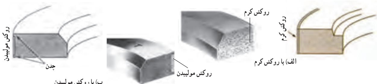
شکل ۲۴-۲- مقطع رینگ‌های تراکم روکش دار
