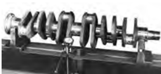
شکل ۱۶۰-۴- دستگاه اندازه‌گیری تاب میل‌لنگ
