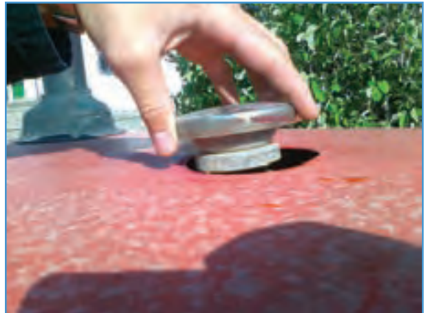
شکل ۷-۳- باز کردن در رادیاتور تراکتور MF285
