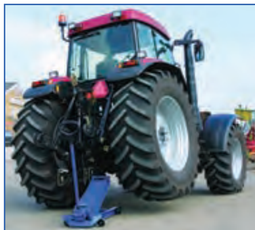
شکل ۱۳-۴- کاربرد جک سوسماری
