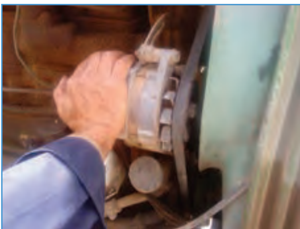
شکل ۳۰-۶ فشار دادن آلترناتور به عقب
