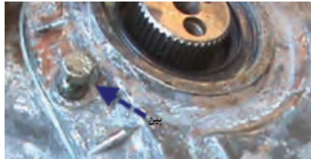
شکل ۴-۶۳- پین هم مرکز کننده کاسه نمد و محور سر میل‌لنگ
