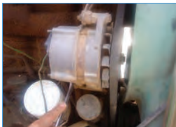
شکل ۳۱-۶ باز کردن پیچ پایه آلترناتور
