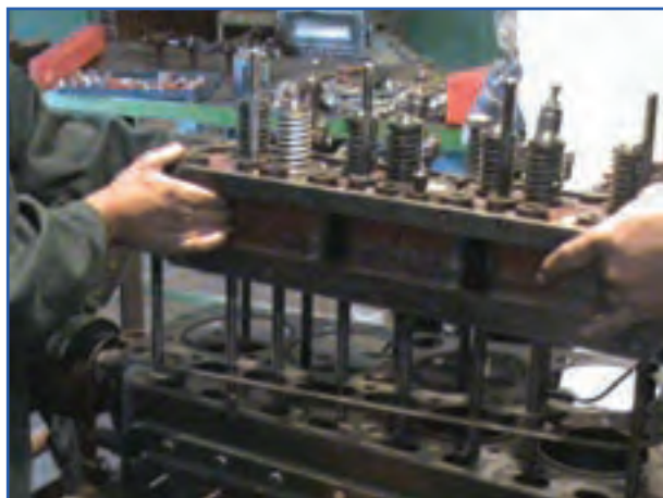
شکل ۱۴-۴- بلند کردن سرسیلندر از روی بدنه سیلندر
