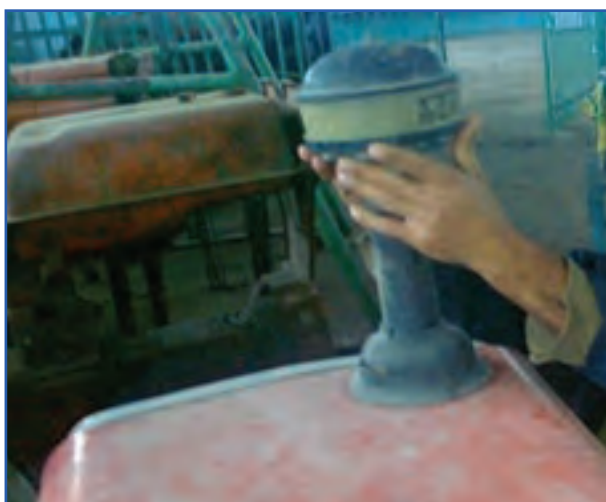
شکل ۲-۳- باز کردن پیش صافی
