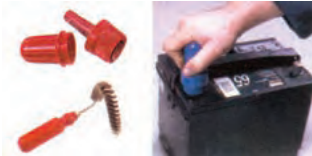
شکل ۲۳-۶- تمیز کردن قطب‌های باتری با ابزار مخصوص
