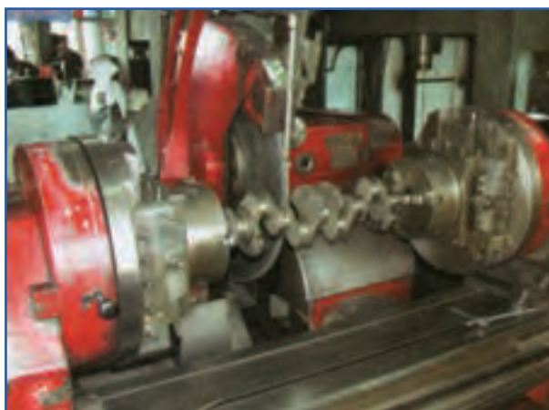
شکل ۱۶۴-۴- دستگاه میل لنگ تراشی
