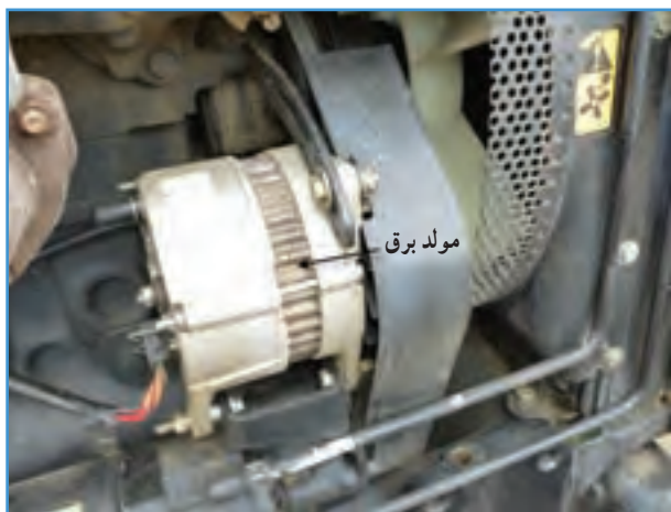
شکل ۴۷-۲- مولد برق تراکتور MF285
