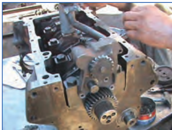
شکل ۷۸-۴- محل بیج‌های پمپ روغن
