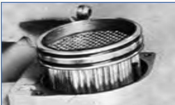
شکل ۳۵-۷- محل قرار گرفتن کویل روغن
