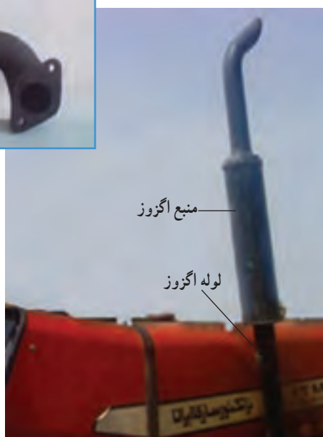
شکل ۲۳-۵- اگزوز تراکتور MF285
