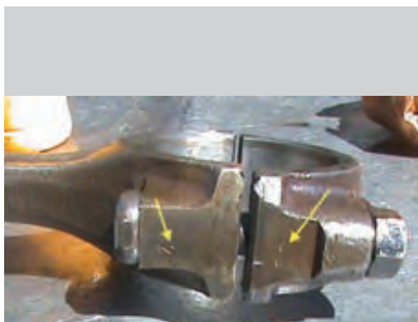
شکل ۸۷-۴- علامت روی کپه شاتون و شاتون
