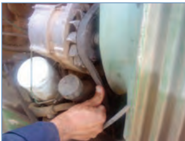
شکل ۲۸-۳- اندازه‌گیری کشش تسمه با فشار انگشت
