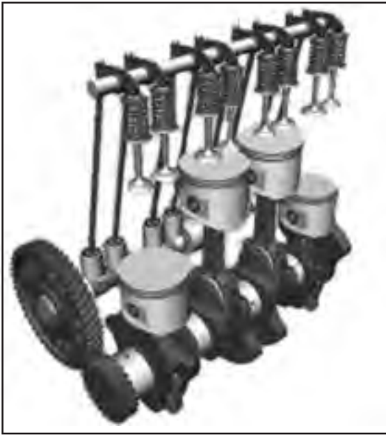
شکل ۸-۲ - قطعات مکانیزم باز و بسته شدن سوپاپها
