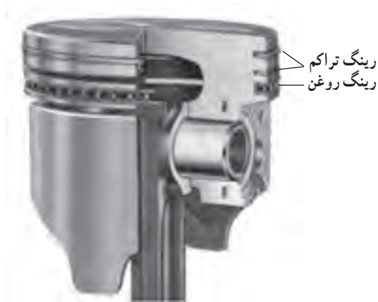
شکل ۲۲-۲- انواع رینگ روی پیستون
