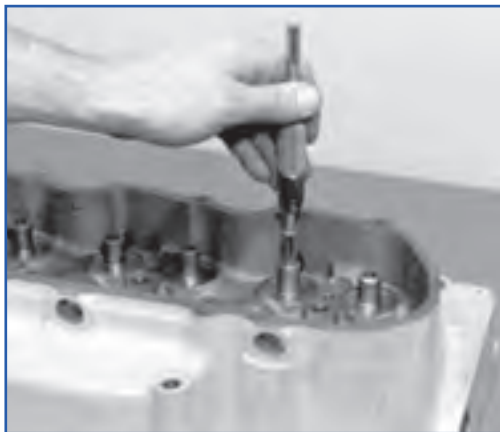
شکل ۴۰-۴- تمیز کردن گیت سوپاپ
