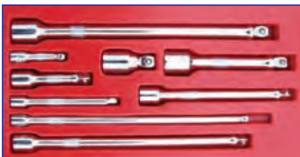
شکل ۴۷-۳- انواع رابط بکس
