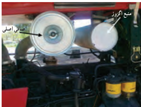
شکل ۲۶-۲- صافی اصلی تراکتور MF399
