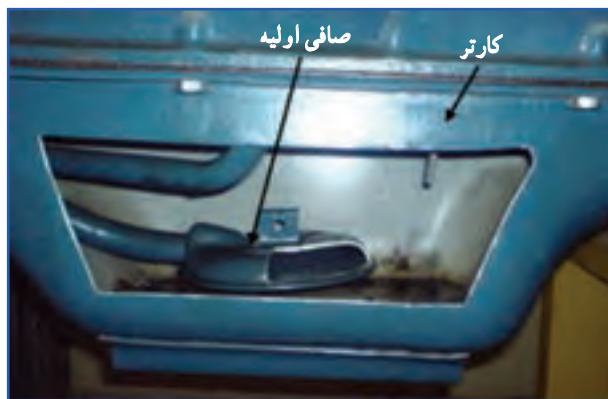
شکل ۲۴-۷- کارتر برش خورده تراکتور U650
