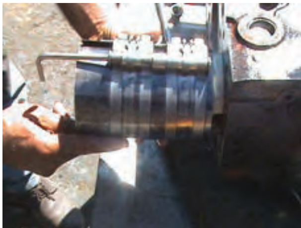
شکل ۱۹۸-۴- جمع کردن رینگها با رینگ جمع کن
