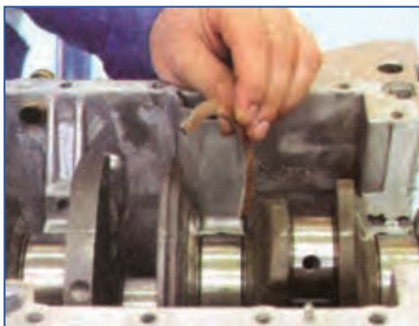
شکل ۱۹۰-۴ - جازدن بغل یاتاقانی
