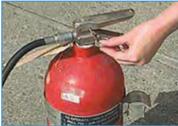
شکل ۱۱-۱- نحوه خارج کردن ضامن کپسول
