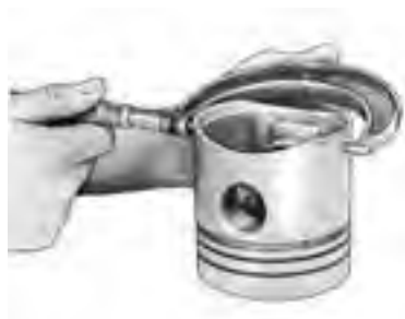
ب) اندازه‌گیری قطر سیلندر با ساعت اندازه‌گیر داخلی
