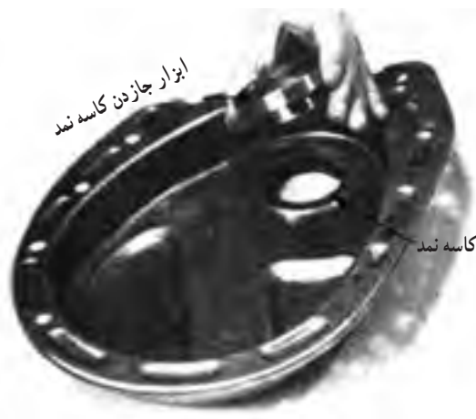
شکل ۴۳-۷- نحوه جازدن کاسه نمد روی سینی جلو
