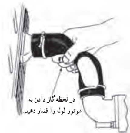
شکل ۲۰-۳- نحوه فشار دادن شیلنگ بالای رادیاتور
