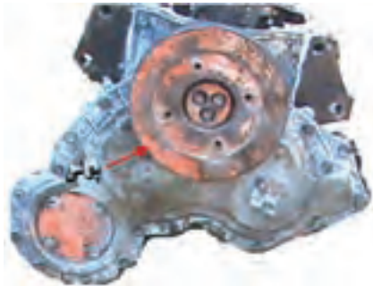
شکل ۴-۶۴- پولی نصب‌شده روی میل‌لنگ
