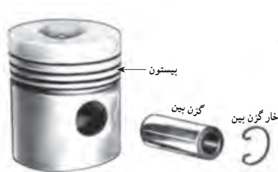
شکل ۳۰-۲- انگشتی و محل نصب آن روی پیستون
