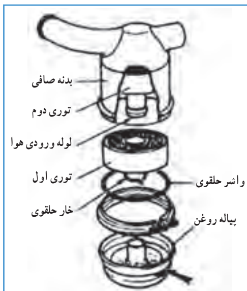
شکل ۸-۵- قطعات صافی روغنی
