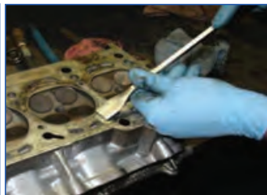
شکل ۴۲-۴- واشر سرسیلندر چسبیده به سیلندر
