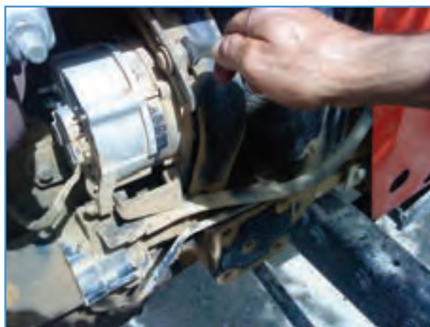
شکل ۲۹-۶ شل کردن پیچ و مهره تنظیم
