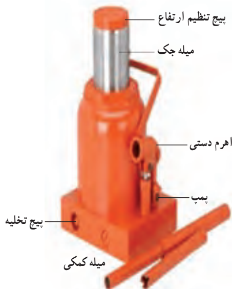
شکل ۹-۴- اجزای جک روغنی
