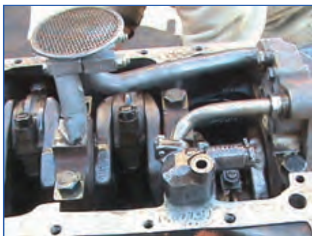
شکل ۸۱-۴- باز کردن لوله خروجی پمپ و سوپاپ فشار
