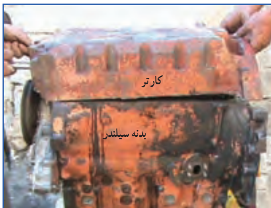
ب) برداشتن کارتر
