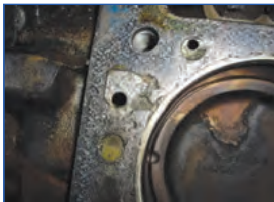
شکل ۴۲-۴- واشر سرسیلندر چسبیده به سیلندر
