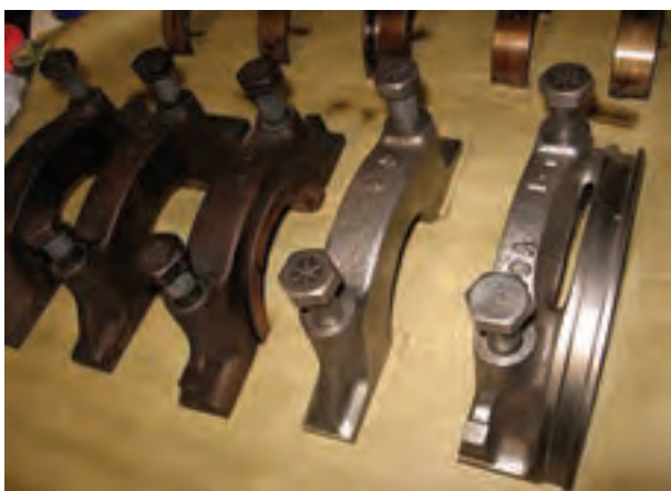
شکل ۱۵۴-۴- چیدن کپه یاتاقان‌ها
