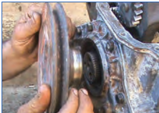
شکل ۴۶-۷- جازدن چرخ تسمه سر میل لنگ
