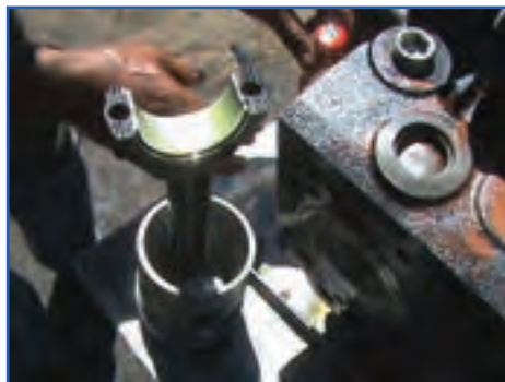
شکل ۱۹۲-۴- روغن‌کاری رینگ‌ها، پیستون و یاتاقان
