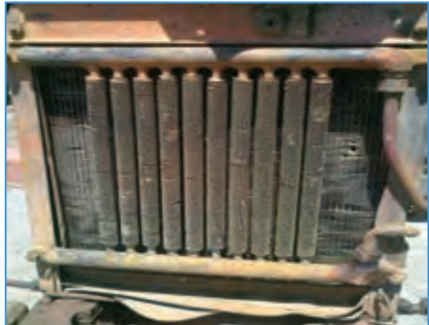
شکل ۱۳-۳- قرار دادن لاستیک بین رادیاتور و محل نشیمن در تراکتور U650M
