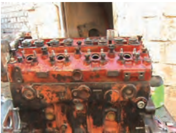
ب) پیچ‌های سرسیلندر باز شده تراکتور MF285
