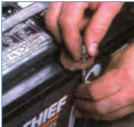
شکل ۹-۶- باز کردن بست نگهدارنده باتری
