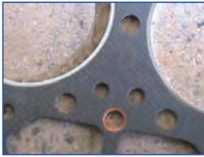
ب) سمت باریک نوار فلزی واشر سرسیلندر
