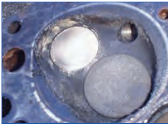
شکل ۴۱-۴- تمیز کردن اتاق احتراق
