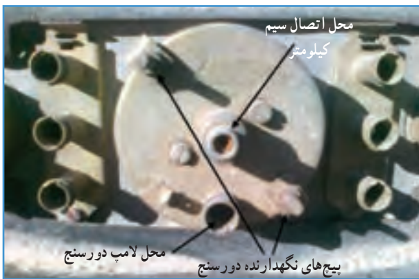
شکل ۸۲-۶- دورسنج از قسمت پشت داشبورد تراکتور U650M
