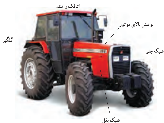
شکل ۲-۲- بدنه و پوشش‌های تراکتور مسی فرگوسن (MF399)
