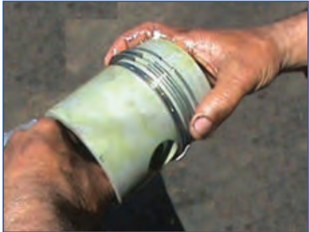
شکل ۱۹۶-۴- تنظیم کردن دهانه رینگها
