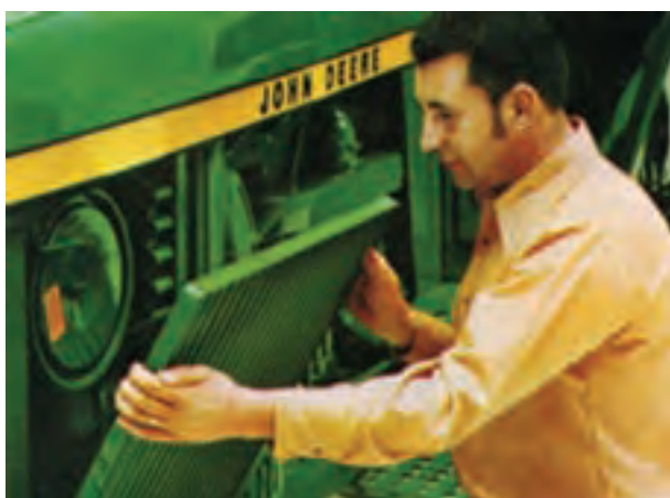
شکل ۱۰-۵ باز کردن شبکه بغل
