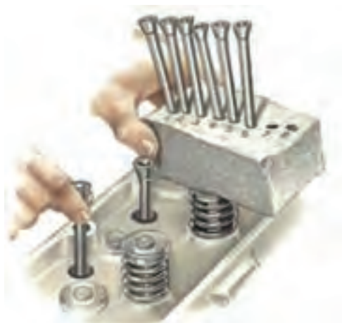
ب) به ترتیب قرار دادن میل تایپت
