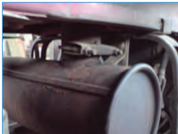
الف) بست اگزوز در تراکتور MF399
