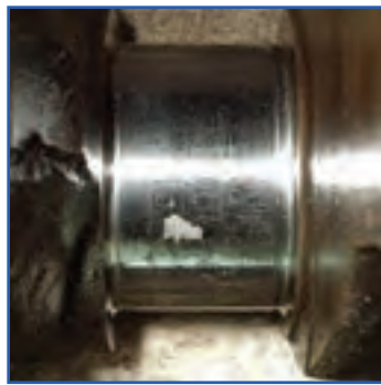
ب) پوسته کردن لایه سخت لنگ
