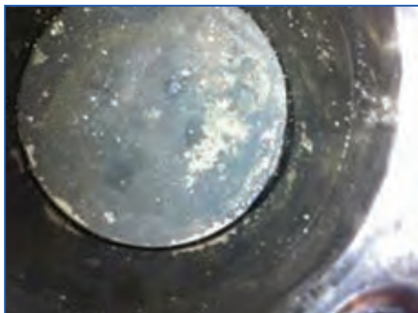
شکل ۲۰۶-۴- رسوبات کربن روی سطح پیستون
