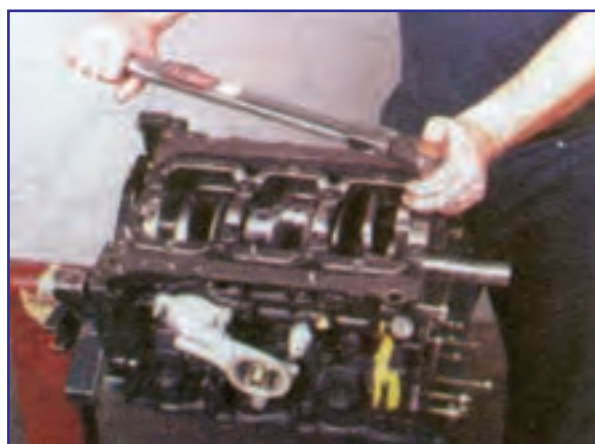
شکل ۳-۵۴- نحوه استفاده از ترک متر خلاصی
