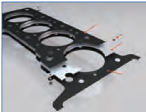
شکل ۴-۴۹- ساختمان واشر سرسیلندر
