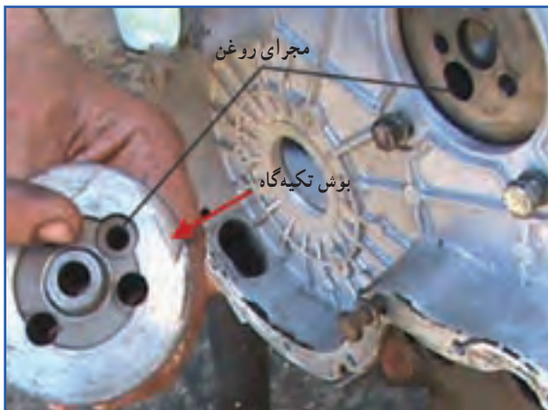
شکل ۶۸-۴ خارج کردن بوش تکیه‌گاه چرخ‌دنده واسط
