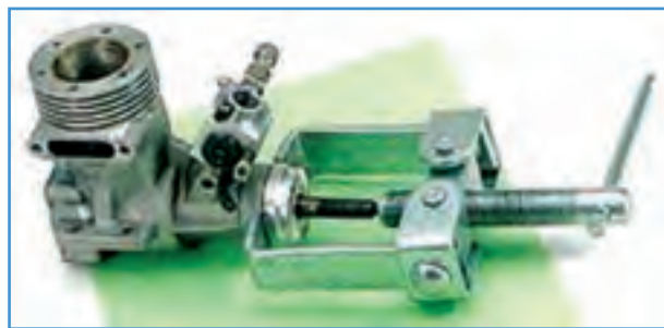
شکل ۷۷-۳- خارج کردن بلبرینگ با بلبرینگ کش
