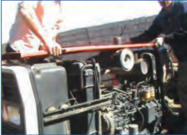
شکل ۱-۴- برداشتن کاپوت از روی موتور
