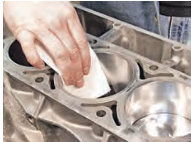
شکل ۲۰۸-۴- تمیز کردن داخل سیلندر
