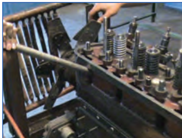
شکل ۱۳-۴- قرار دادن اهرم در مجرای دود
