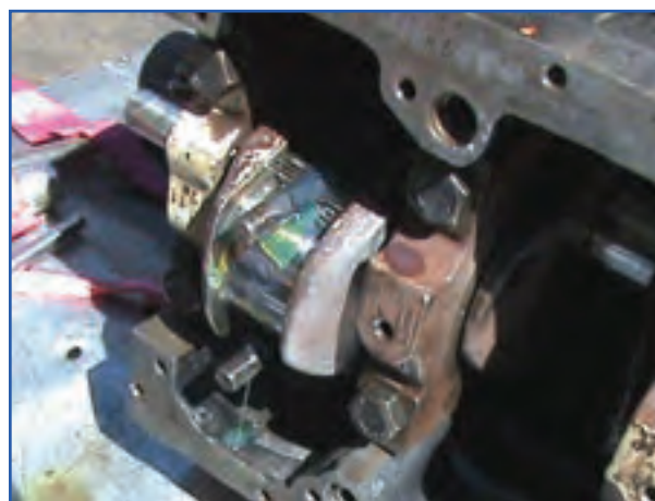
شکل ۲۰۳-۴- جا زدن شاتون روی میل لنگ
