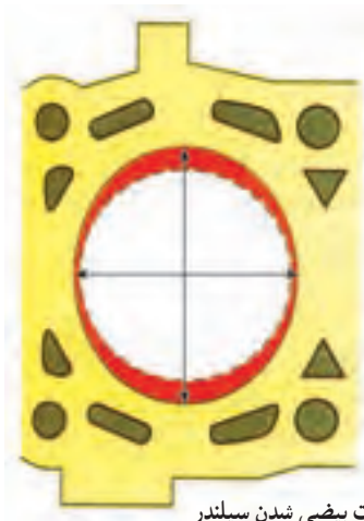
شکل ۱۴۹-۴- وضعیت بیضی شدن سیلندر
