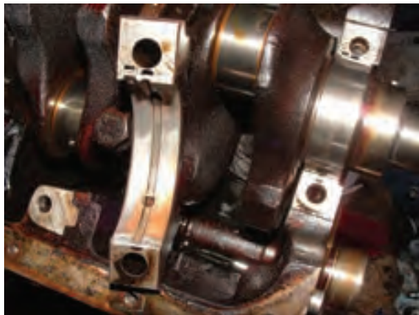
شکل ۱۸۲-۴- باز کردن کپه یاتاقان نابت
