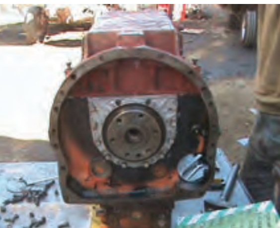
شکل ۱۵۰-۴- انتهای میل لنگ بدون چرخ لنگر
