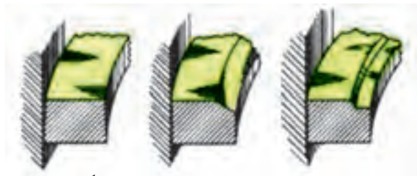
شکل ۴-۱۳۲- فرم خاص در لبه داخلی رینگ
