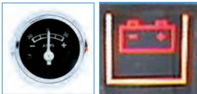
الف) چراغ هشدار دهنده شارژ ب) درجه شارژ
