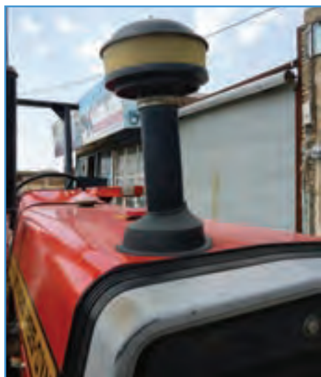
شکل ۲۵-۲- پیش صافی تراکتور MF285
