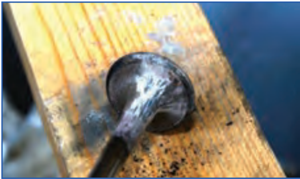
(ب) سوپاپ تمیز شده با کاردک
