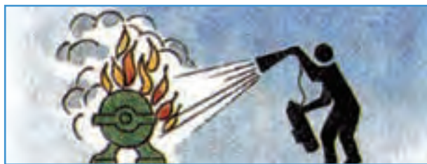
شکل ۱۴-۱- خاموش کردن آتش با دی اکسید کربن
