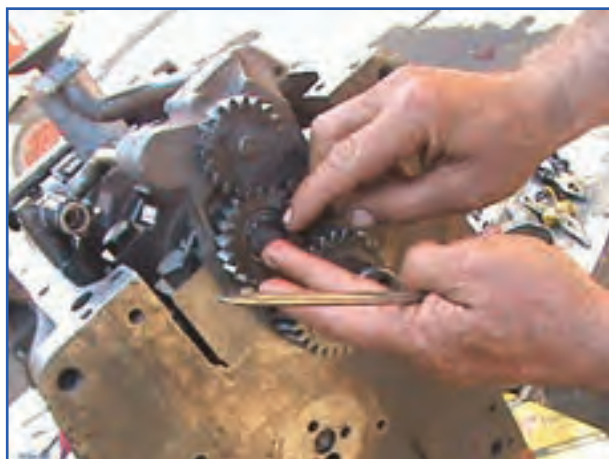
شکل ۷۹-۴- خارج کردن خار چرخ‌دنده پمپ روغن
