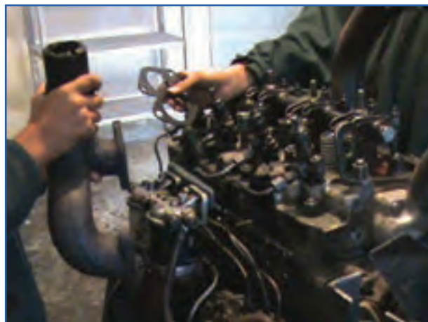
شکل ۴-۴- باز کردن مانیفولد هوا
