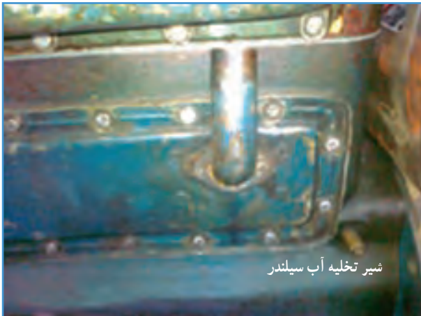
شکل ۸-۳- شیر تخلیه آب سیلندر تراکتور U650
