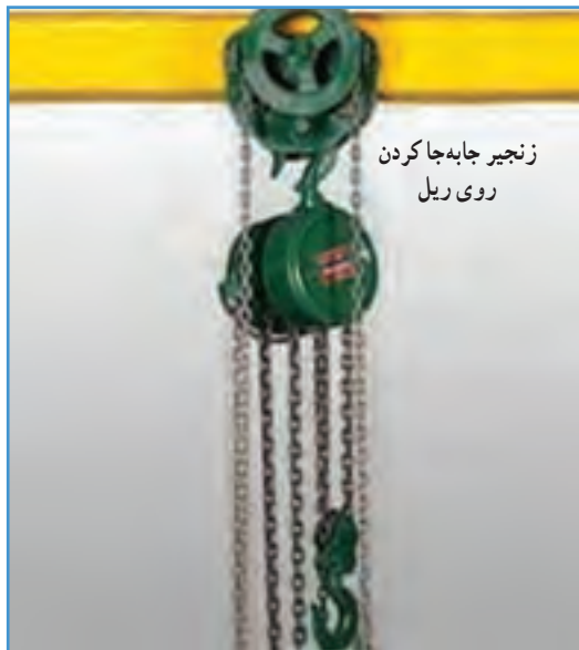
شکل ۲۰-۴- اتصال جرثقیل سقفی به ریل
