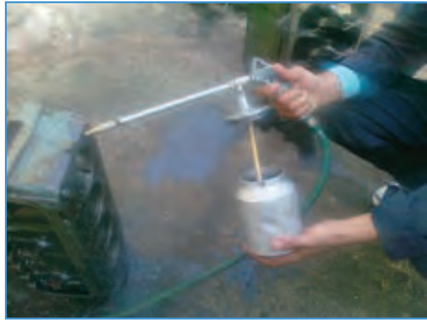
شکل ۱-۳- باز کردن مخزن پیستوله شستشو
