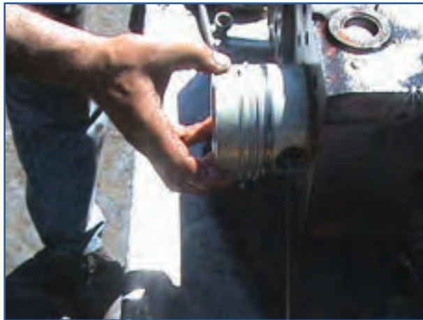
شکل ۱۹۷-۴- قرار دادن پیستون در سیلندر
