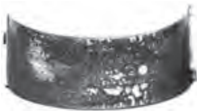
شکل ۱۶۸-۴ اثرات سوختگی روی یاتاقان
