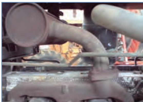
شکل ۳۰-۵- محل اتصال منبع اگزوز به مانیفولد
