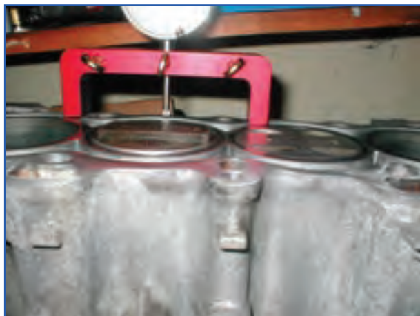
شکل ۲۰۵-۴- کنترل ارتفاع پیستون
