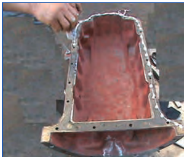
شکل ۳۲-۷- چسب زدن به محل قرارگیری واشر کارتر
