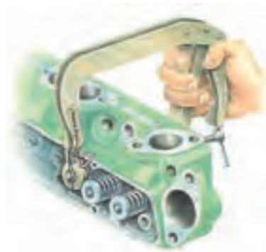
شکل ۱۷-۴- نحوه قرار دادن سوپاپ باز کن روی سوپاپ‌ها
