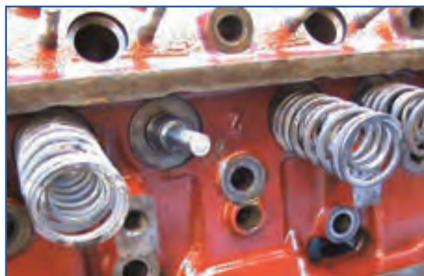
شکل ۲۱-۴- نحوه برداشتن فنر سوپاپ
