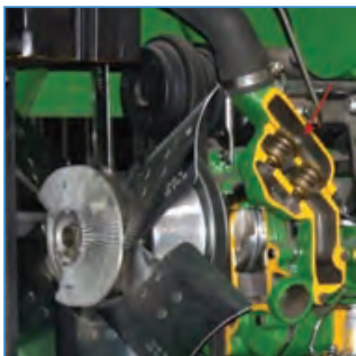
شکل ۲۴-۳ - طرز صحیح قرار گرفتن ترموستات
