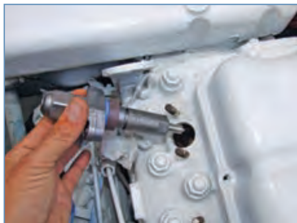
شکل ۲۳-۴- خارج کردن انژکتور
