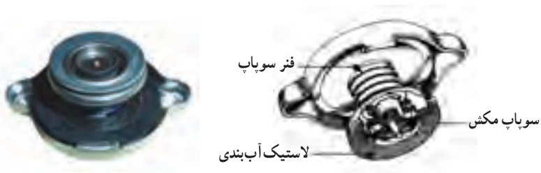
ب) اجزای در رادیاتور
