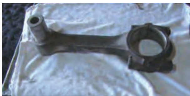
شکل ۱۲۱-۴ امتحان کردن انگشتی روی شاتون
