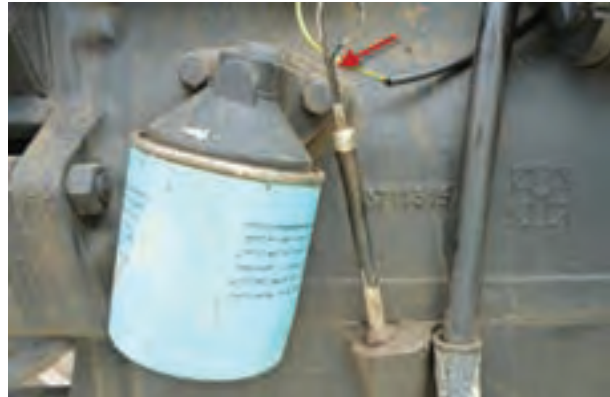
شکل ۳۰-۷- میله سنجش سطح روغن تراکتور MF285
