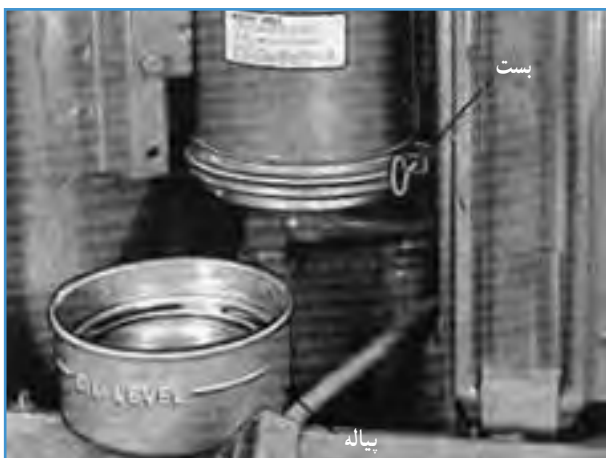
شکل ۱۷-۵- باز کردن پیاله زیر صافی
