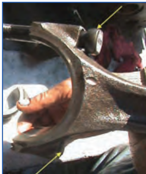
شکل ۸۵-۴- خارج کردن پیچ شاتون
