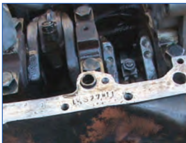
شکل ۸۲-۴- محفظه میل‌لنگ بدون پمپ روغن
