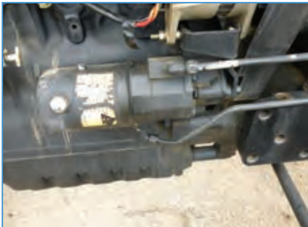
شکل ۲۳-۲- پمپ هیدرولیک فرمان و صافی تراکتور MF285
