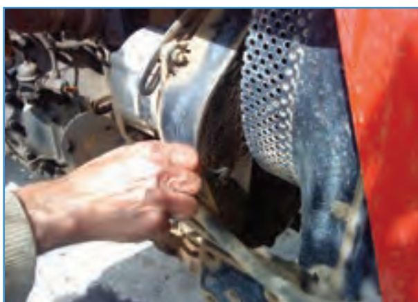
شکل ۳۲-۶ باز کردن روکش محافظ تسمه
