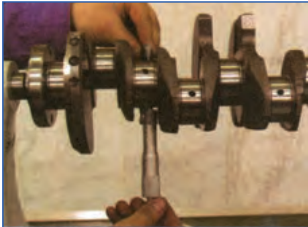
شکل ۱۶۲-۴- اندازه‌گیری قطر محورهای میل‌لنگ
