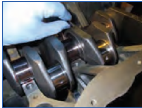
شکل ۱۸۳-۴- خارج کردن بغل یاتاقانی
