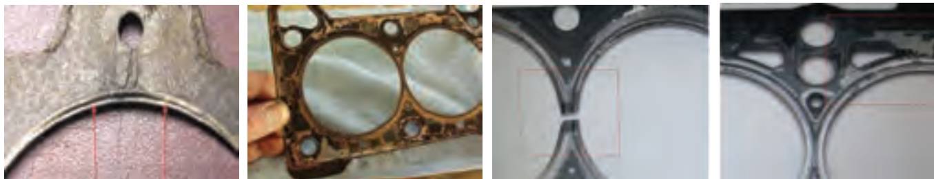
شکل ۵۰-۴- نواحی سوخته شده واشر سیلندر
