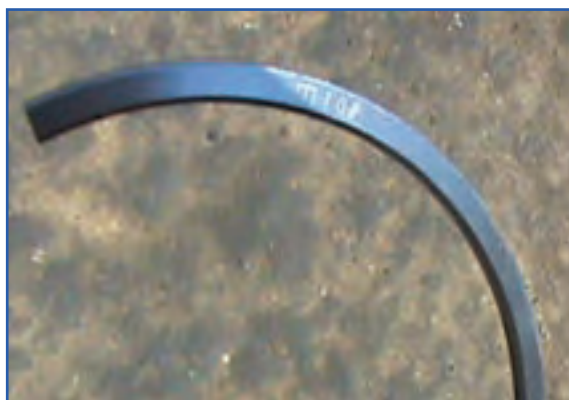
شکل ۴-۱۳۴- علامت TOP روی رینگ
