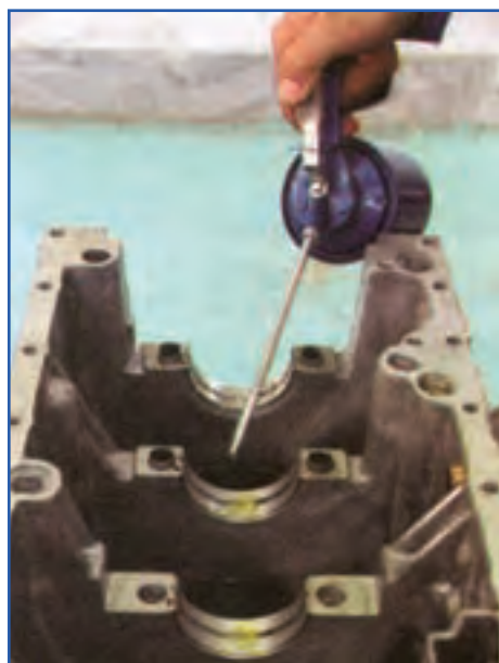
شکل ۱۸۷-۴ روغن کاری یاتاقان‌های ثابت
