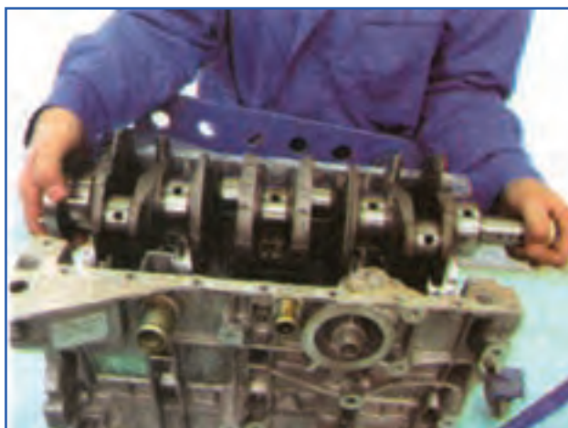
شکل ۱۸۸-۴ - قرار دادن میل‌لنگ روی تکیه‌گاه یاتاقان‌های بدنه سیلندر
