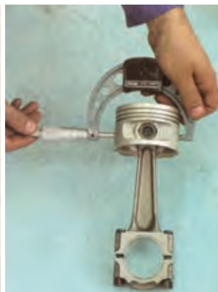
الف) اندازه‌گیری قطر دامن پیستون
