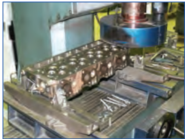
شکل ۳۲-۴- دستگاه کف تراشی سرسیلندر
