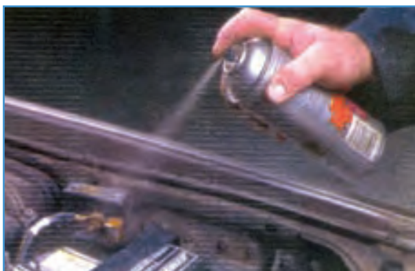
شکل ۱۱-۶- پاشیدن اسپری ضد خوردگی روی بست باتری
