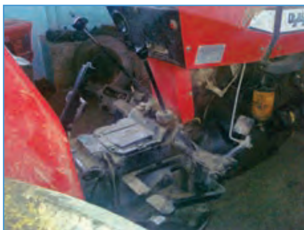
شکل ۲۱-۲- اهرم‌های تعویض دنده و دنده کمک
