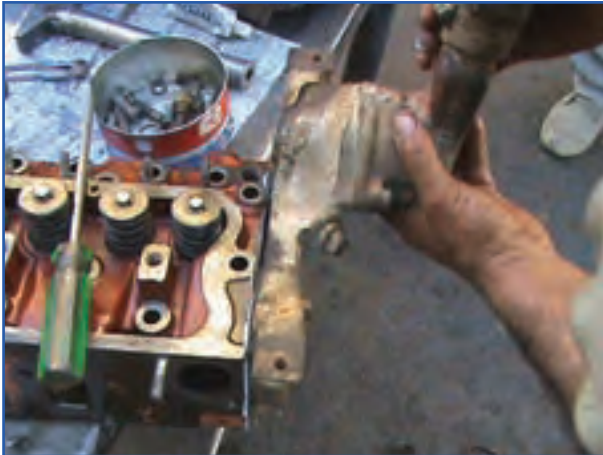
ب) باز کردن محافظه ترموستات تراکتور MF399
