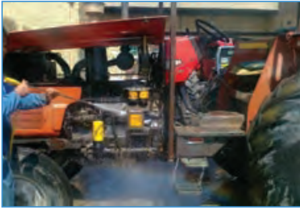
شکل ۵-۱- شستشوی موتور تراکتور
