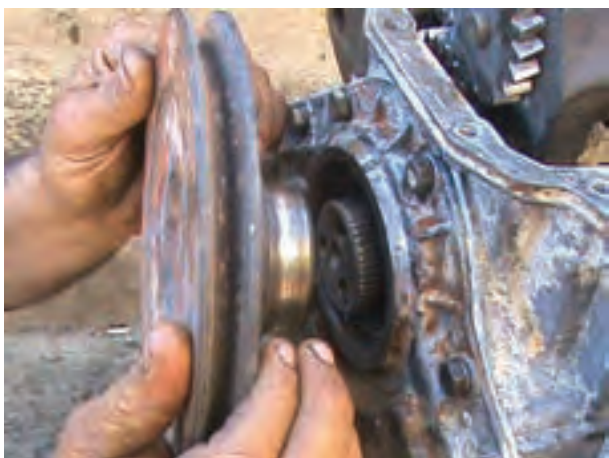
شکل ۴-۵۷- خارج کردن پولی میل لنگ
