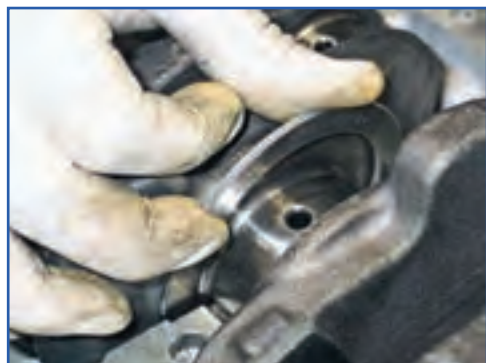
شکل ۱۸۴-۴- جازدن بغل یاتاقانی
