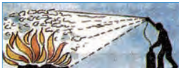
شکل ۱۵-۱- خاموش کردن آتش با کف
