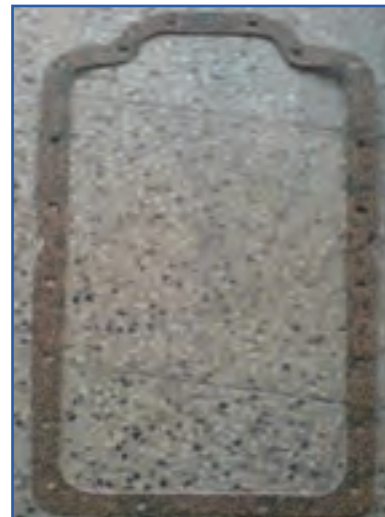
(الف) واشر کارتر ویکتوری MF285
