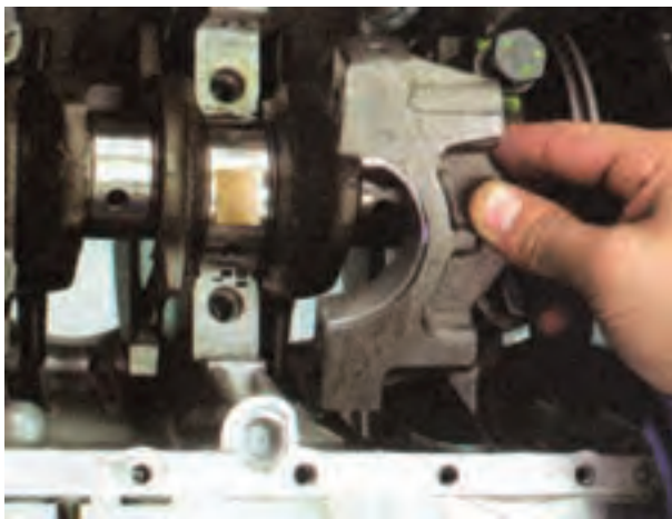
شکل ۱۷۳-۴ بستن کپه یاتاقان لایه گذاری شده
