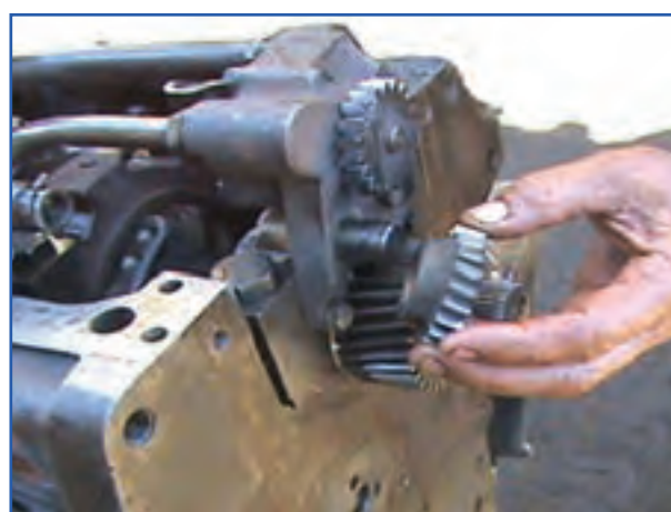
شکل ۸۰-۴- خارج کردن چرخ‌دنده پمپ روغن
