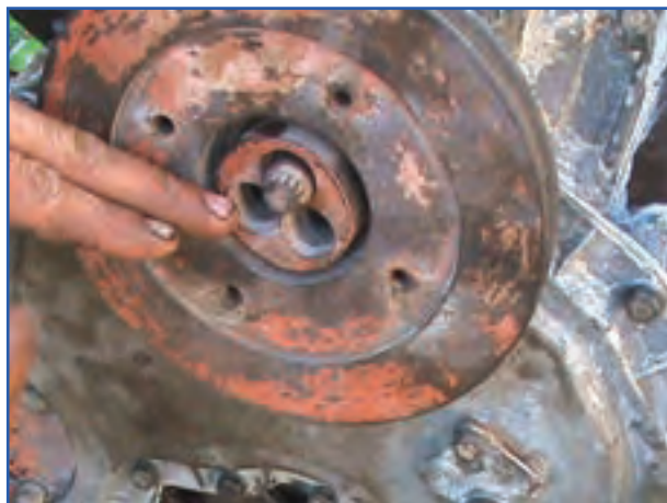
شکل ۴-۵۵- بستن پیچ سر میل لنگ تراکتور
