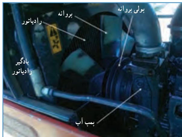
شکل ۳۴-۲ رادیاتور تراکتور MF285
