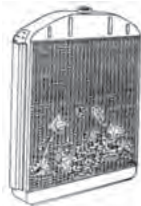
شکل ۹-۳- مواد کثیف کننده سطح رادیاتور
