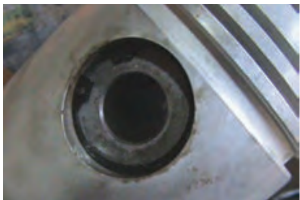
شکل ۱۲۵-۴- جا افتادن خار انگشتی در شیار پیستون
