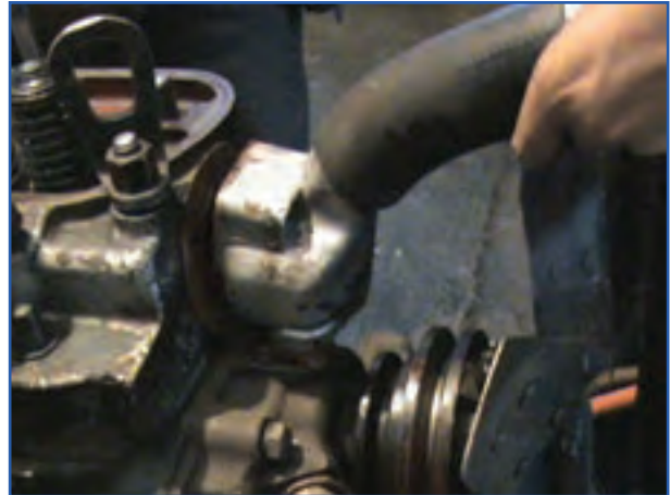
الف) باز کردن محافظه ترموستات تراکتور u650
