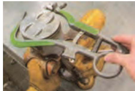
(ب) کاربرد ابزار تمیزکننده شیپار رینگ‌ها
