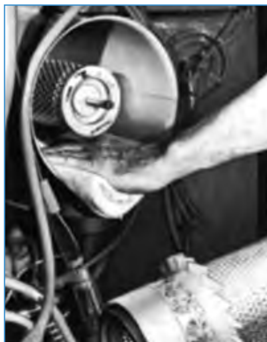
شکل ۱۳-۵ تمیز کردن بدنه صافی با پارچه
