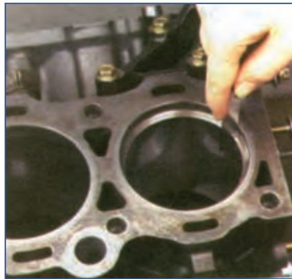
شکل ۱۲۸-۴- طرز اندازه‌گیری دهانه رینگ با فیلر
