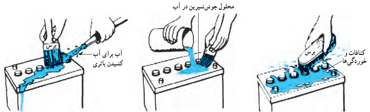
الف) تمیز کردن با برس و آب
