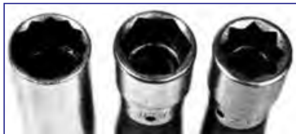
شکل ۳۵-۳- آچار بکس شش، هشت و دوازده گوش
