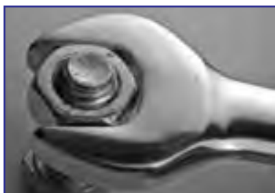
شکل ۲۸-۳ آچار تخت با سر زاویه دار (اینچی)
