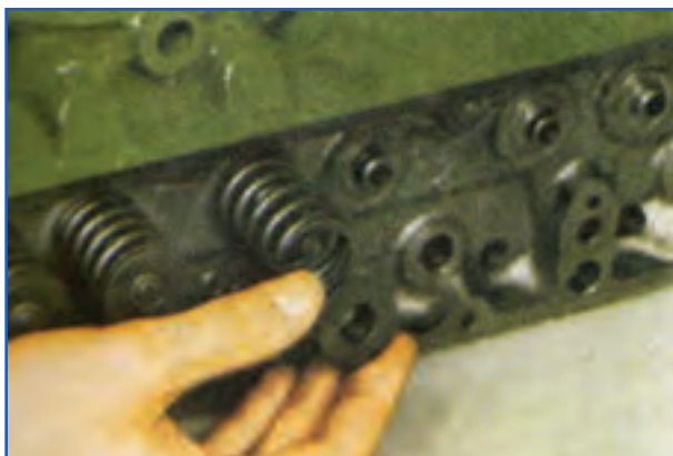
شکل ۲۰-۴- نحوه برداشتن بشقابک فنر سوپاپ
