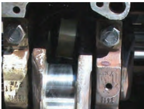
شکل ۸۸-۴- شاتون در حال خارج شدن
