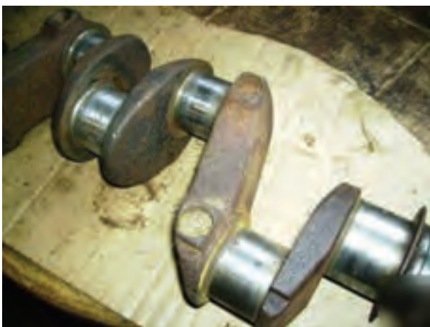
شکل ۲۱۰-۴- میل‌لنگ با رسوبات کربن
