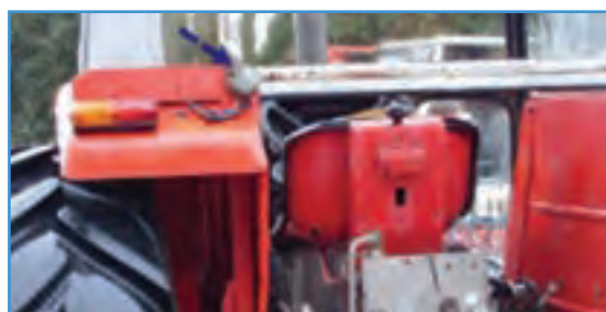
شکل ۱۶-۲- چراغ راهنمای تراکتور MF285
