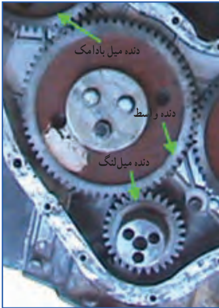
شکل ۱۲-۲- نسبت دنده میل بادامک به میل لنگ
