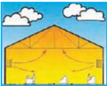
تصویر ۱-۲- مقایسه‌ی سیستم‌های گرمایشی جابه‌جایی و تابشی
