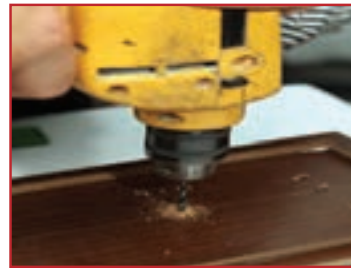
پ- سوراخ کردن در جعبه با دریل
