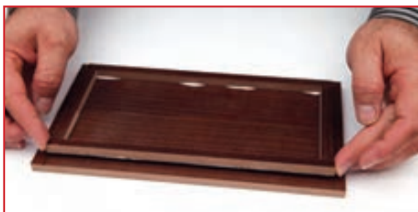
ب- قرار دادن زوار زیر در جعبه
