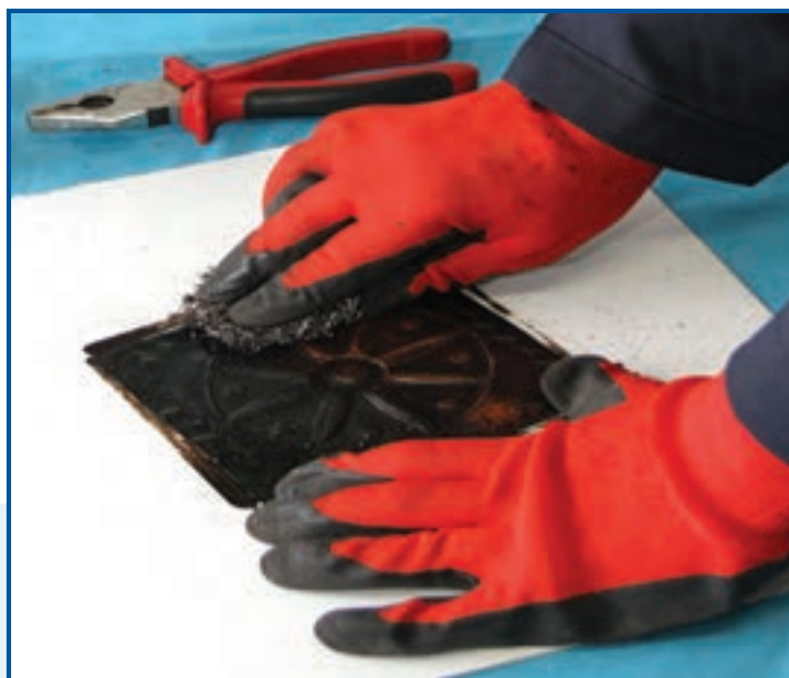
شکل ۱۱-۱۰- ساب زدن سطح پلاک مسی
