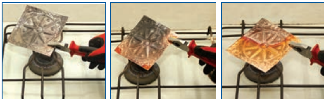
شکل ۸-۱- حرارت دادن پلاک مسی
