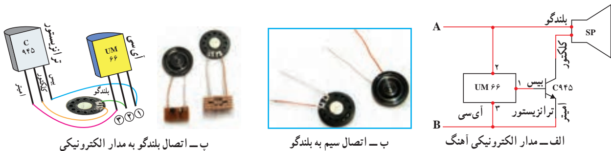
شکل ۲-۲۶- مدار الکترونیکی جعبه آهنگ
