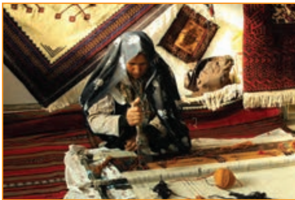
شکل ۱۱-۴- استفاده از دفتین
