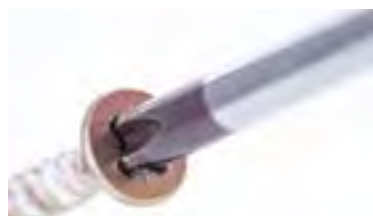
الف) استفاده صحیح از آچار پیچ گوشتی
