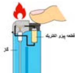
شکل ۱۱(ج) - کاربرد پیزوالکتریک در فندک
