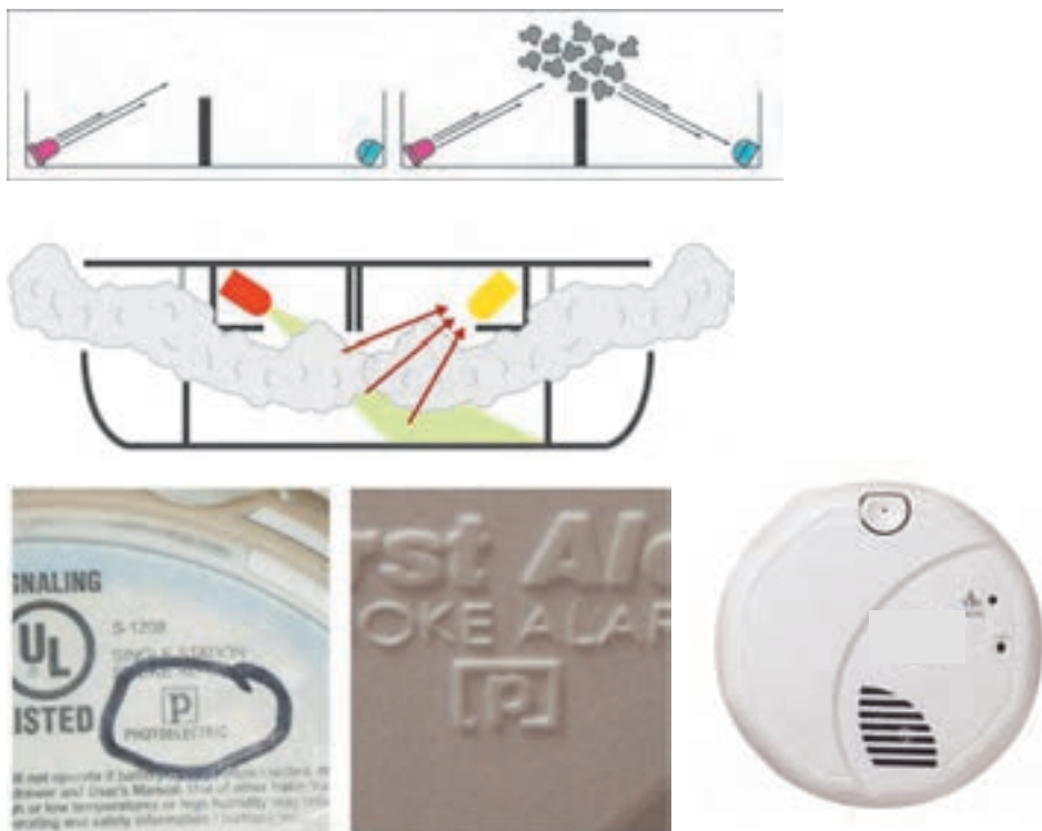
شکل ۳۲ - عملکرد دتکتور دودی و علامت مشخصه آن
