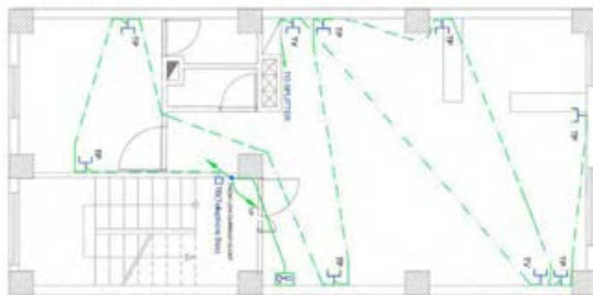
شکل ۱۰ - نقشه سیم‌کشی پریز تلفن و پریز آنتن
