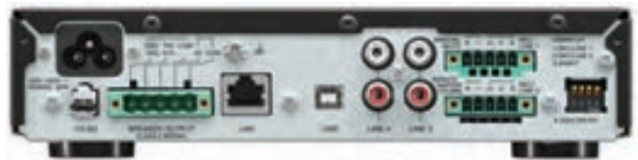
شکل ۱۹- اتصالات آمپلی فایر
