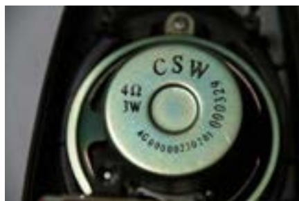
شکل ۹- توان بلندگو و آمپدانس
