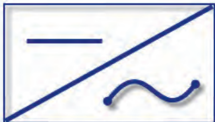
شکل ۴- تبدیل ولتاژ مستقیم به متناوب
