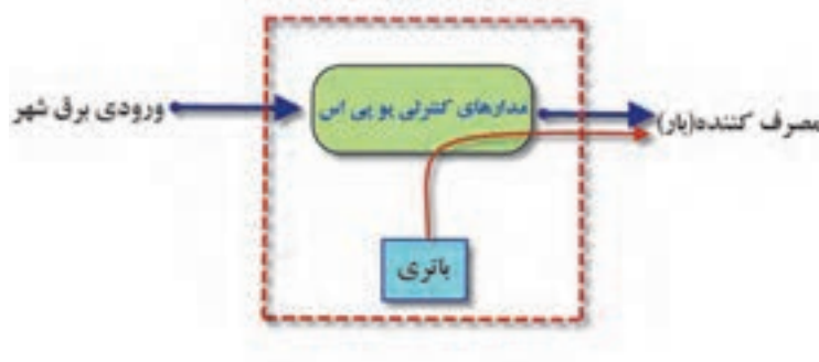
شکل ۳- مدار کنترلی یو پی اس
