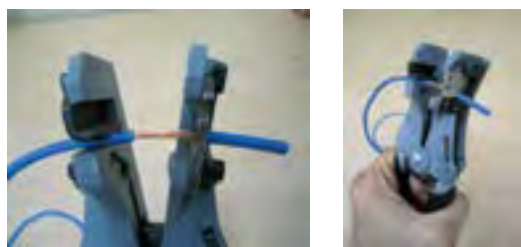
شکل ۱-۱۰- شکل روکش برداری با سیم لخت کن اتوماتیک
