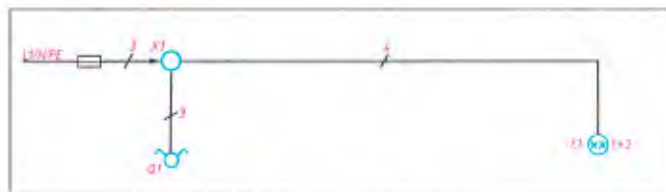
شکل ۳۰ - ۳- شمای فنی مدار کلید دویل
