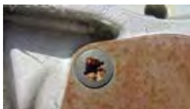
ب) استفاده ناصحیح از آچار پیچ گوشتی
