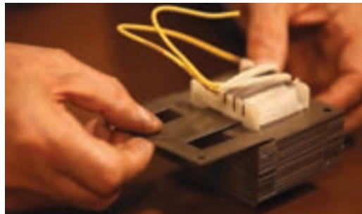
شکل ۳۷- جا زدن هسته
