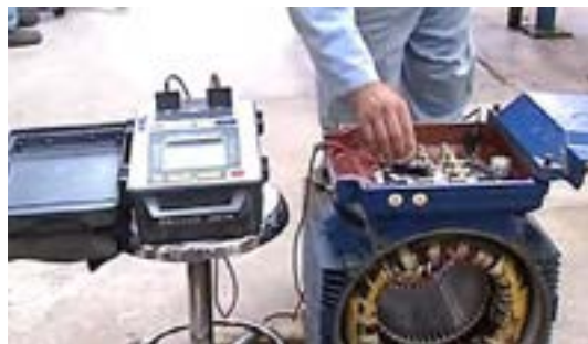
آزمایش تست بدنه موتور با دستگاه میگر
