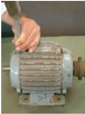
شکل ۱۵- علامت گذاری قطعات جداشونده موتور با سمبه نشان
