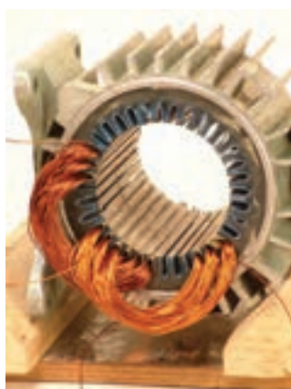
شکل ۶۸- قرار گرفتن دومین گروه کلاف در شیارها
