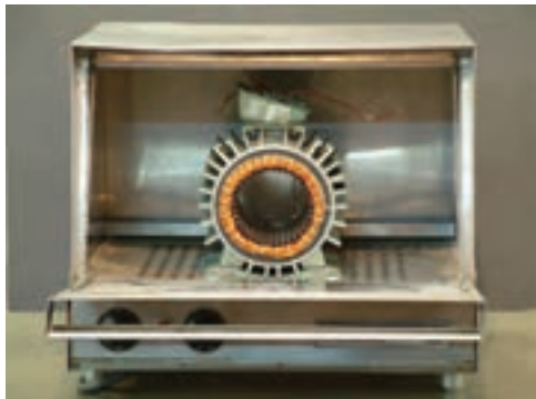
شکل ۲۲- گرم کردن سیم پیچ
