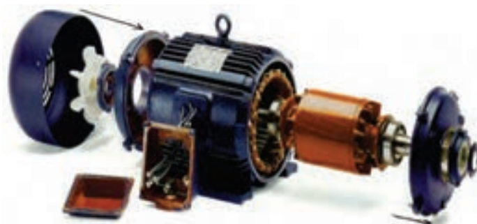
شکل ۱۹- ترتیب و توالی باز کردن قطعات موتور
