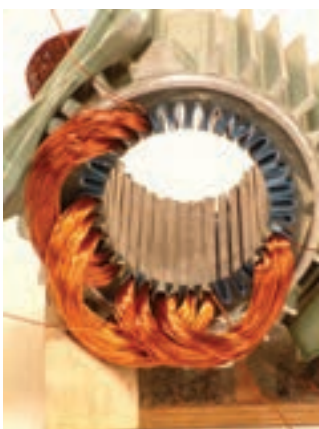
شکل ۶۹- قرار گرفتن سومین گروه کلاف در شیارها
