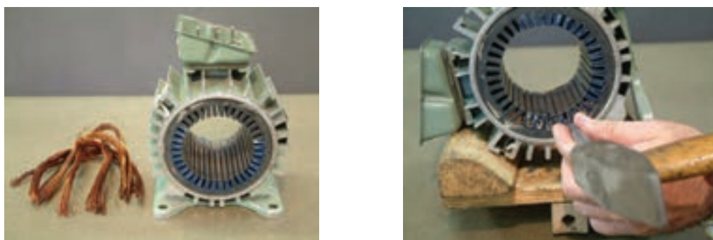
شکل ۲۴- سیم های خارج شده از شیارها
