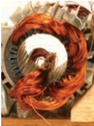
شکل ۷۰- درآوردن بازوهای ۱،۲،۳ برای قرار دادن کلاف آخر
