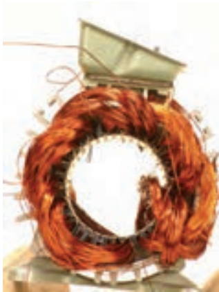
شکل ۷۱- قرار گرفتن آخرین گروه کلاف در شیارهای استاتور
