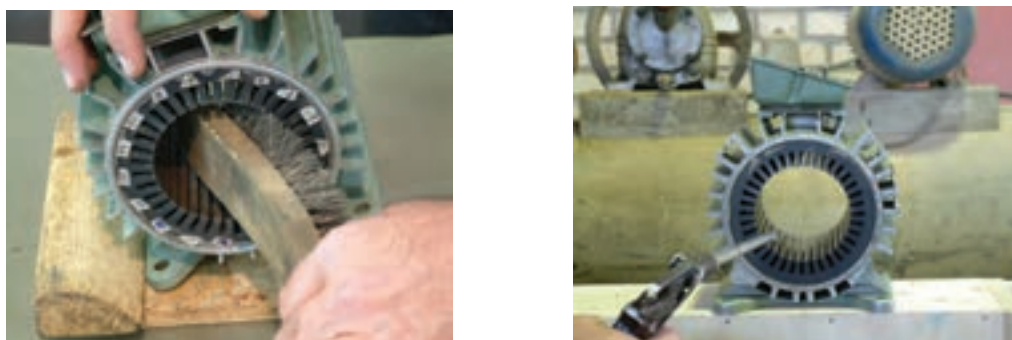
شکل ۲۵-۱ داخل شیارها را با برس تمیز کنید
