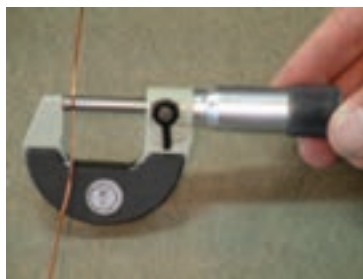
شکل ۲۶- اندازه گیری قطر سیم و شمارش تعداد دور یک بازو
