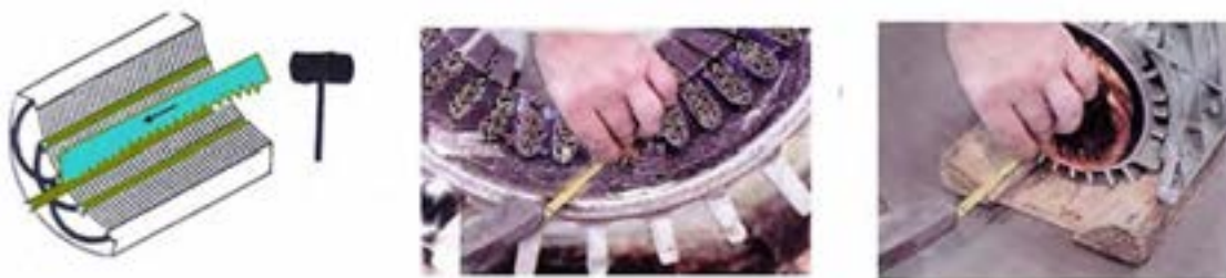
شکل ۲۳- خارج کردن پرسیان از شیارها
