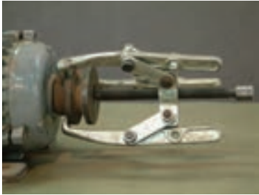
شکل ۱۷- در آوردن پولی از محور موتور
