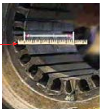
شکل ۲۷- اندازه گیری طول و قطر داخلی استاتور
