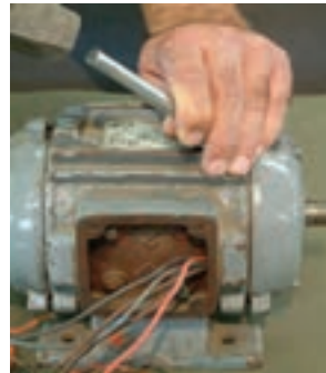
شکل ۱۸- باز کردن پیچ‌های موتور و درپوش‌ها
