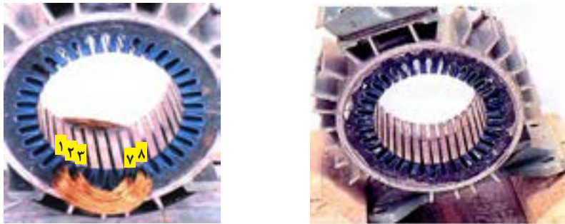
شکل ۲۶- جای‌گذاری گروه کلاف شماره ۱ در شیارهای ۲ به ۸ و ۳ به ۷
