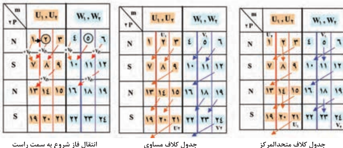
شکل ۲۱- جدول موتور ۲۴ شیار ۴ قطب طرح دوفاز یک طبقه با گام کسری
