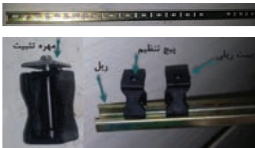
شکل ۳۱- بست ریلی و ریل مربوطه
