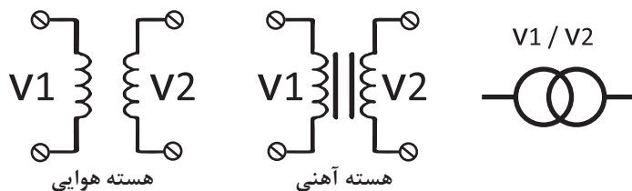
شکل ۳- علائم اختصاری ترانسفورماتور با هسته های مختلف
