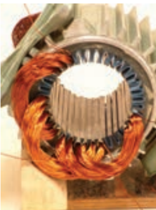
شکل ۶۹- قرار گرفتن سومین گروه کلاف در شیارها
