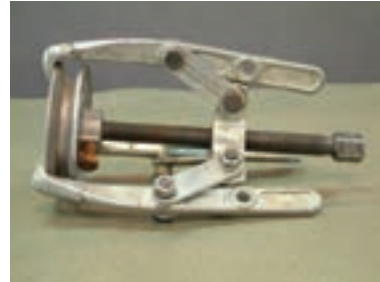
شکل ۱۷- در آوردن پولی از محور موتور
