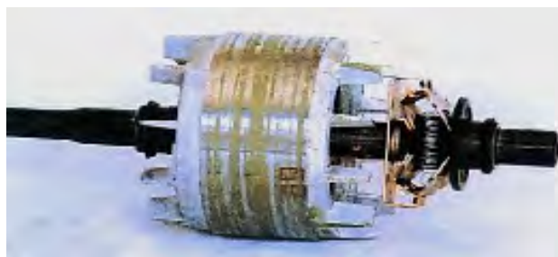
شکل ۹- محل قرار گرفتن کلید گریز از مرکز
