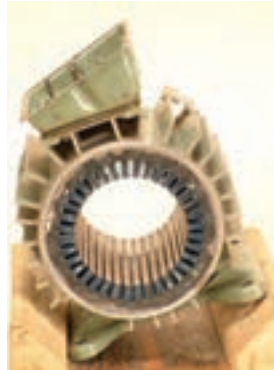
۲۹-۲- استاتور عایق کاری شده
