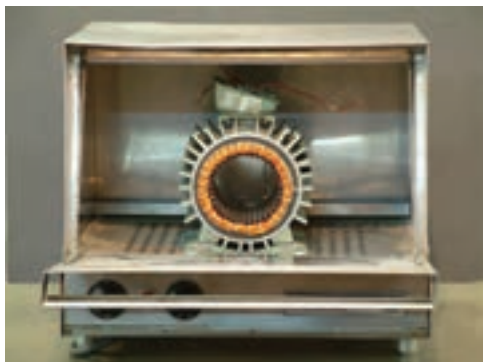
شکل ۲۲- گرم کردن سیم پیچ
