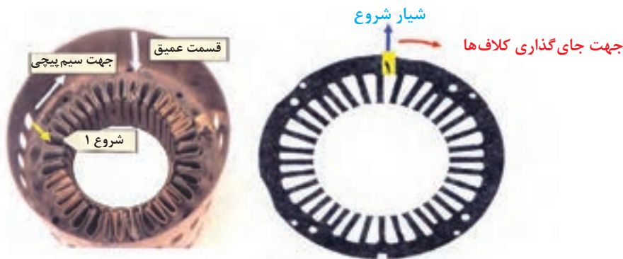
شکل ۴۶- عمق متفاوت شیارها و روش انتخاب شیار شروع سیم پیچی
