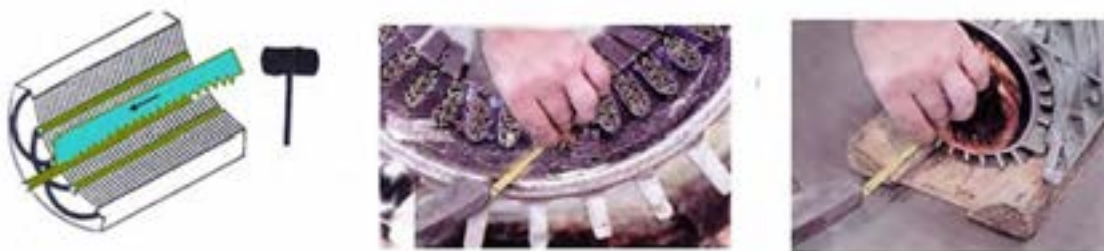
شکل ۲۳- خارج کردن پرسیان از شیار
