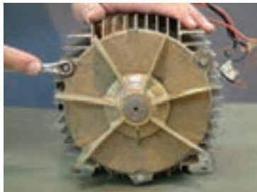
شکل ۱۸- باز کردن پیچ‌های موتور و درپوش‌ها
