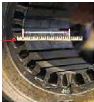
شکل ۲۷- اندازه گیری طول و قطر داخلی استاتور
