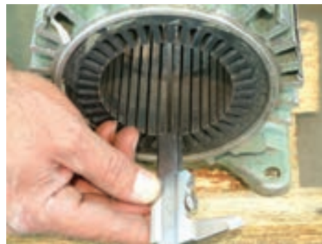
شکل ۲۷- اندازه گیری طول و قطر داخلی استاتور
