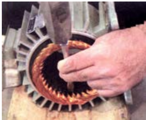
شکل ۲۱- بریدن سیم‌ها توسط قلم
