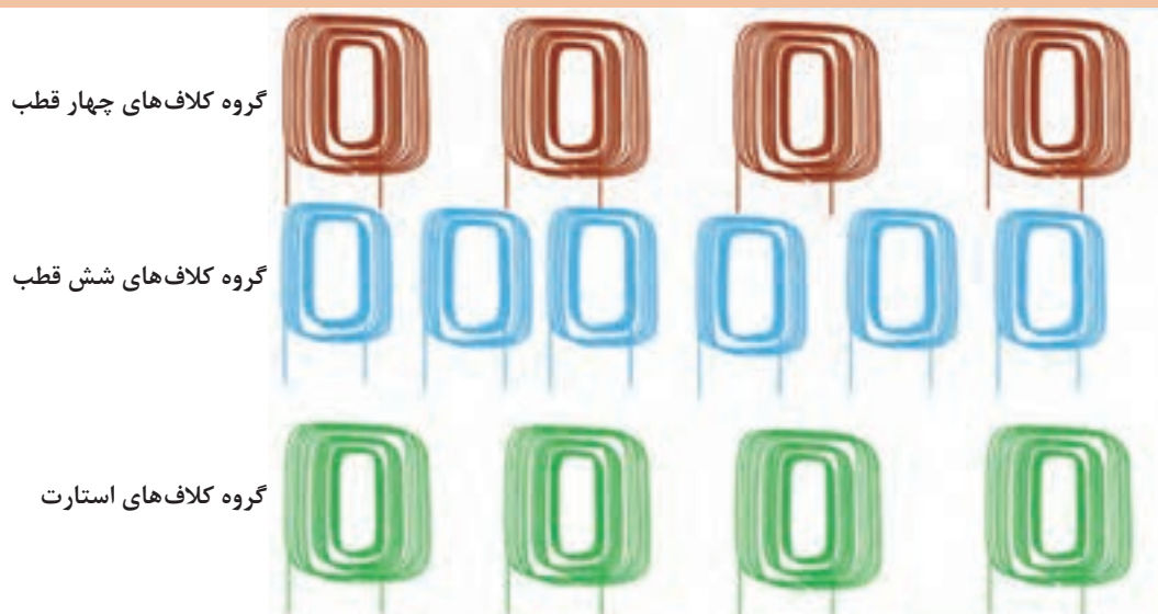
شکل ۴۷- تهیه گروه کلاف های سیم پیچی
