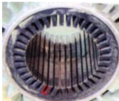
(الف) اندازه‌گیری سطح داخل شیار
