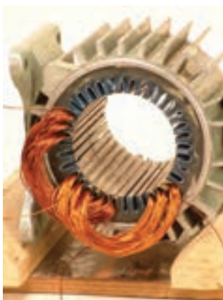
شکل ۶۸- قرار گرفتن دومین گروه کلاف در شیارها
