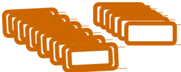
شکل ۲۴- ۶ گروه کلاف دو پیچگی و ۶ کلاف تک پیچگی
