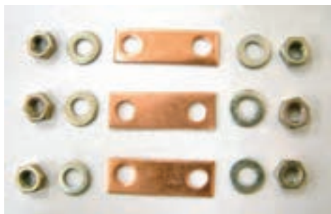
شکل ۲۶- اتصال تسمه مسی
