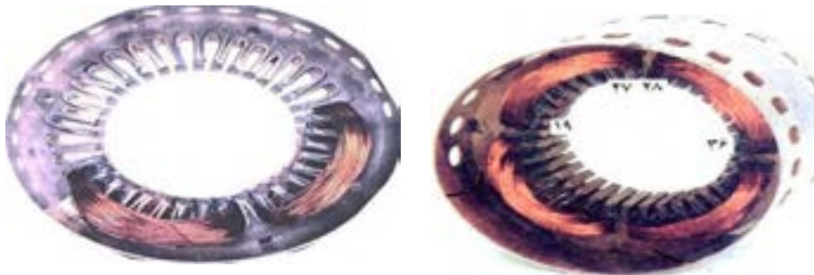
شکل ۴۹- قرار دادن گروه کلاف های دور تند در شیارهای استاتور
